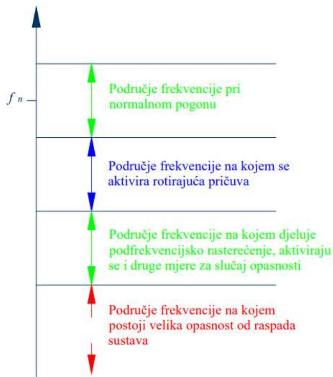
Slika 4.6. Stanja sustava ovisna o frekvenciji [3]
