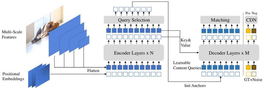
Slika 5. Arhitektura DETR modela. Ovaj model poboljšava DETR dodavanjem nekoliko komponenata. Usporedbom sa Slikom 4. vidi se da izlaz iz koder slojeva prolazi kroz još jedan dodatan sloj te izlazi iz tog dodatnog sloja služe kao vektori ulaza za predikciju objekata na slici korištenjem dekodera. To je najbitnija razlika između DETR i DINO modela. [8]
