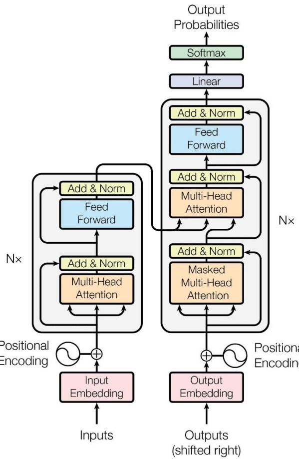
Slika 1. Arhitektura transformer [1]. Lijevo se nalazi koder, a desno dekoder. Ulaz se prvo pretvara u niz vektora pogodan za *Transformer*. Tim vektorima se dodaje informacija o poziciji u nizu. Zatim ulaz prolazi kroz koder dio *Transformera* te će se izlazi iz kodera koristiti u dekoder dijelu modela kako bi se generirali novi izlazi.
