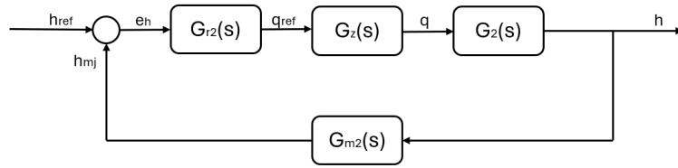
**Slika 4.4.** Pojednostavljeni matematički model laboratorijskog postava u otvorenom krugu
