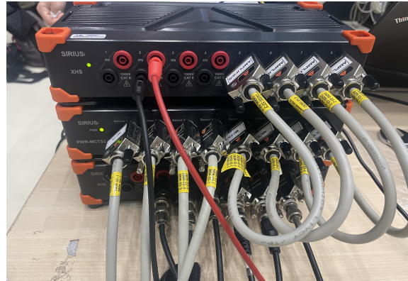
Slika 6.7: Generator niskofrekvencijskog signala i pojačalo (lijevo) i akvizicijski sustav Dewesoft (desno)
