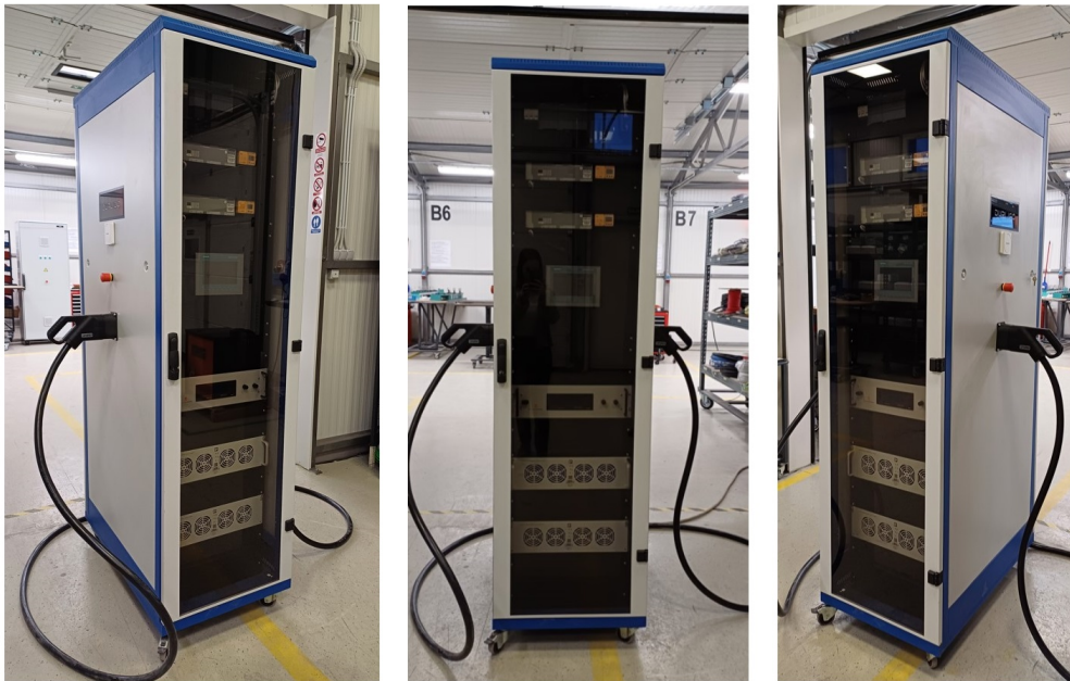
Slika 4.2: Slika montirane punionice
