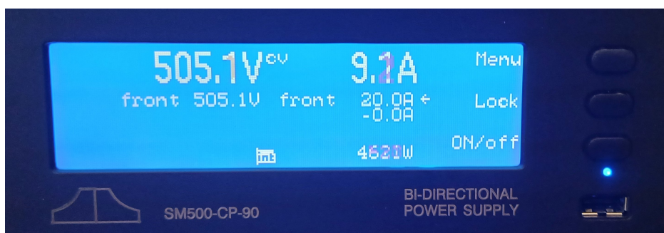
Slika 8.4: DC izvor za vrijeme punjenja jednog vozila na fizičkom postavu
