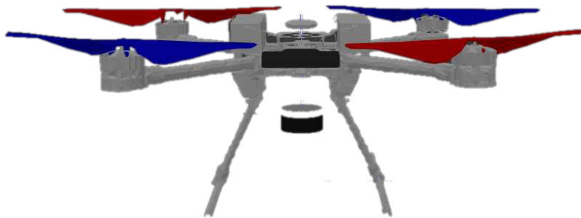
Slika 4.3: Prednji prikaz modela drona i LiDAR senzora
