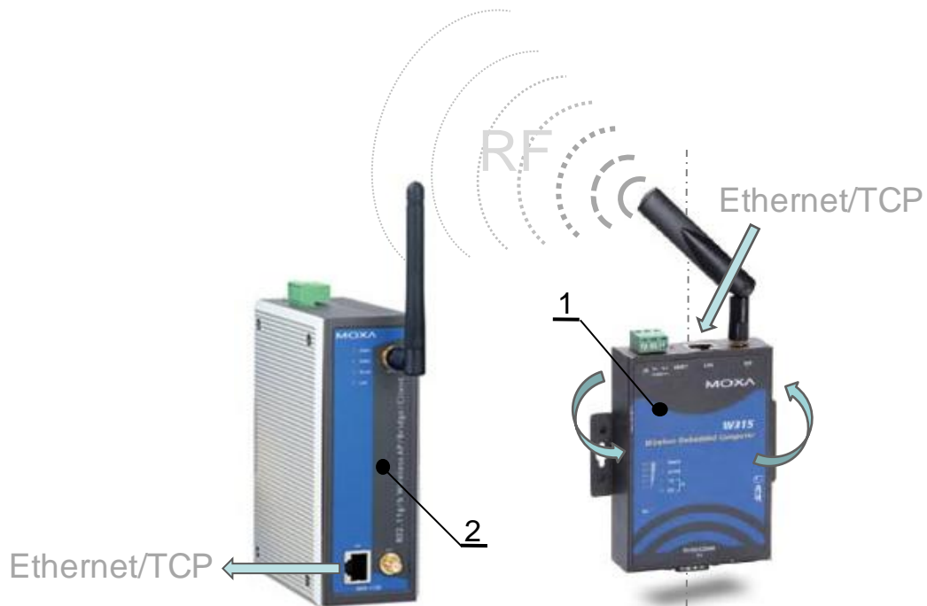
Slika 5.16. Bežični prijenos podataka; 1 – predajnik, 2 – prijemnik.
