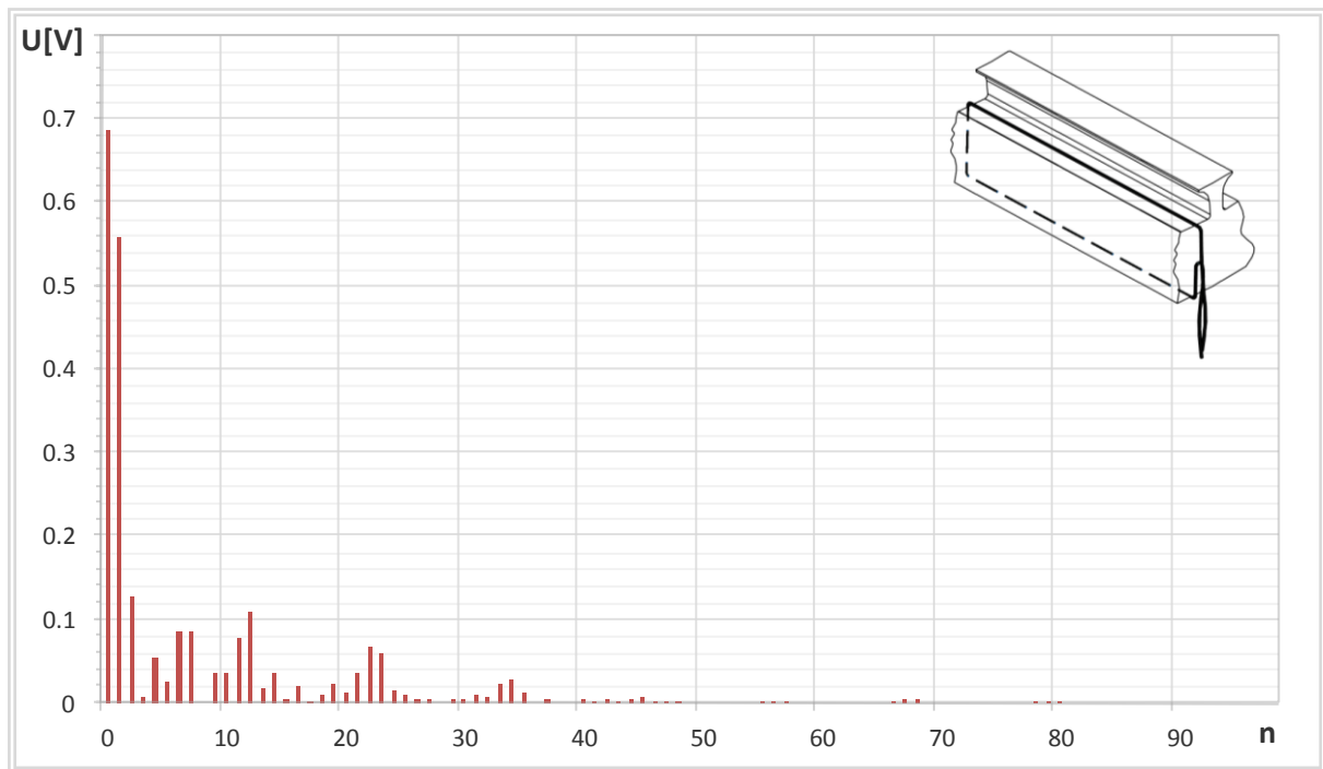
Slika 6.58. Frekvencijska analiza valnog oblika napona inducirano u mjernom svitku M_{s3} i M_{s4} , na polnom koraku pola broj 4, uz sniženi broj zavoja pola broj 4 od 10 %, pri uzbudnoj struji 4 A.
