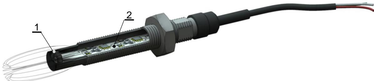
Slika 5.8. Induktivni senzor: 1 – jezgra sa zavojnicom, 2 – elektroničko sklopovlje.
