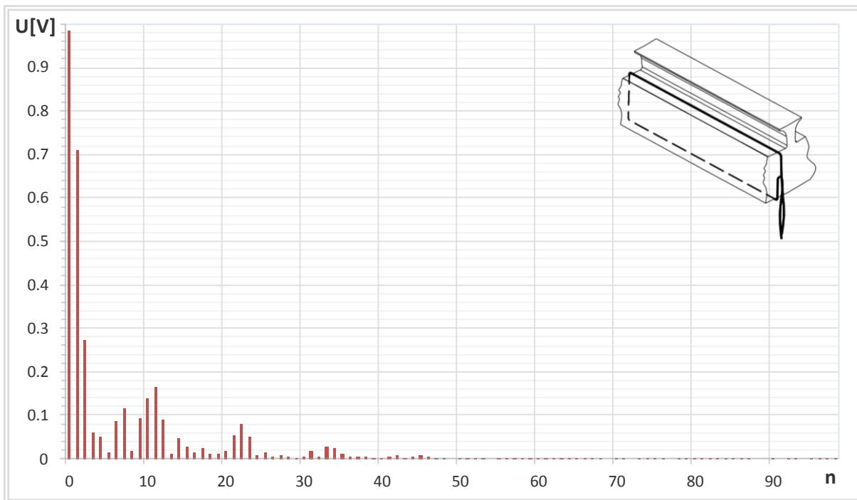
Slika 6.57. Frekvencijska analiza valnog oblika napona induciranih u mjernom svitku  $M_{s3}$  i  $M_{s4}$ , na polnom koraku pola broj 4, uz sniženi broj zavoja pola broj 4 od 10 %, pri uzbudnoj struji 8,7 A.
