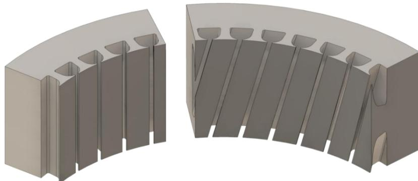
*Slika 8.7. Stator: Lijevo - bez skošenja utora, Desno - sa skošenjem utora.*
