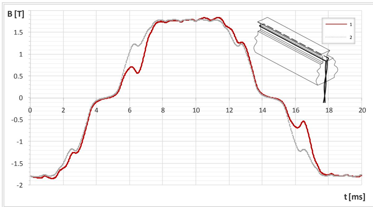
*Slika 6.81. Raspodjela magnetske indukcije dobivena integracijom napona induciranih u mjernom svitku  $Ms_1$ , za prazni hod generatora:
