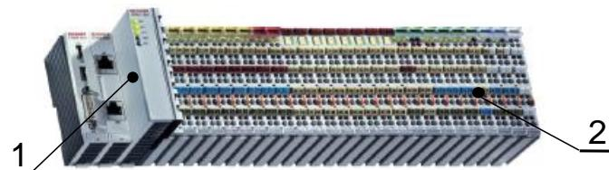
Slika 5.15. Procesna jedinica; 1 – kontroler, 2 – mjerni modul.
