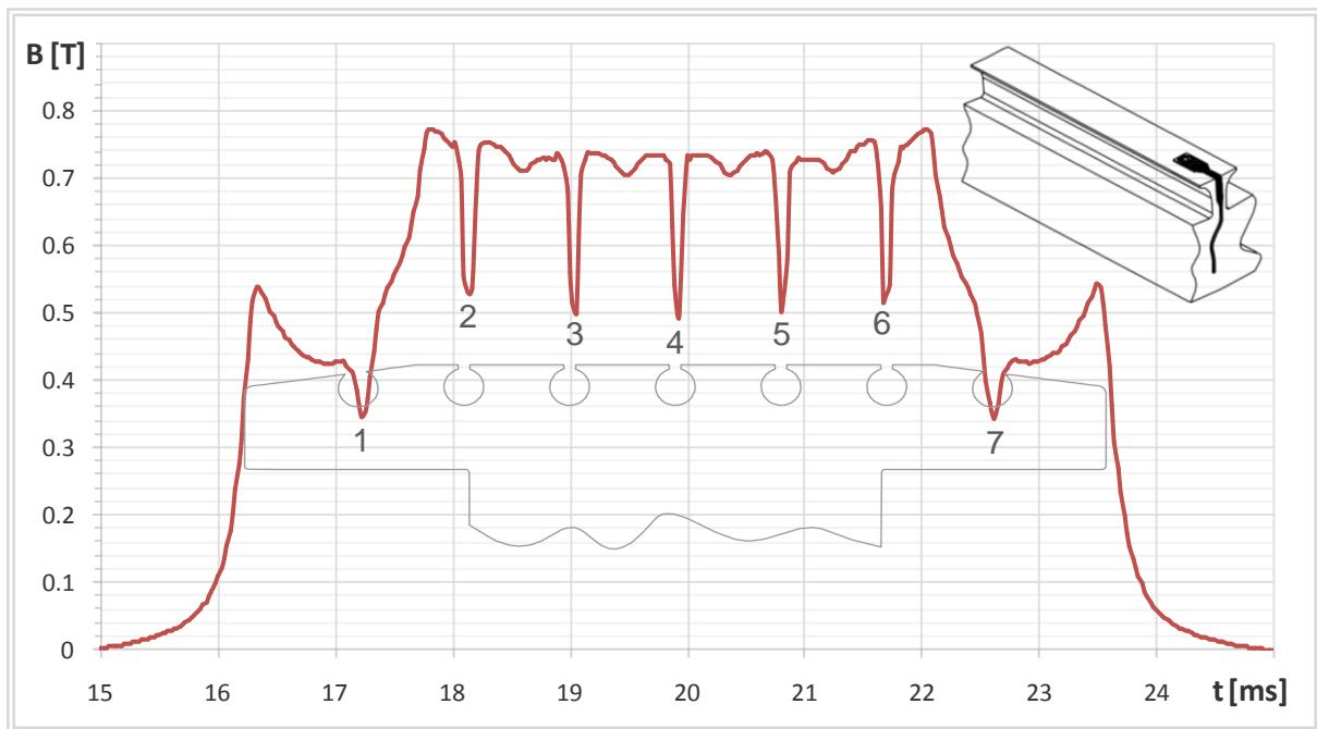
*Slika 6.4. Raspodjela magnetske indukcije u zračnom rasporu promatrana sa zuba statorskog paketa za prazni hod pri uzbudnoj struji od 8,7 A, prikazana zajedno s konstrukcijskim izmjerama pola rotora*
