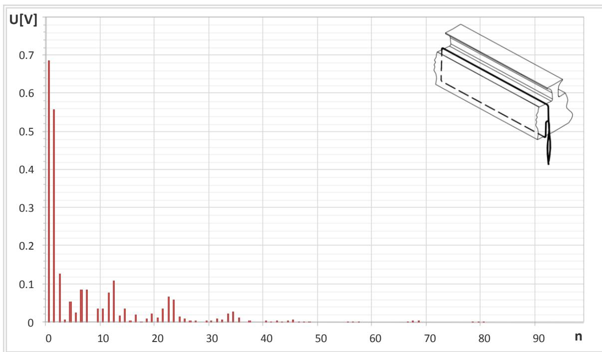
Slika 6.58. Frekvencijska analiza valnog oblika napona induciranih u mjernom svitku  $M_{s3}$  i  $M_{s4}$ , na polnom koraku pola broj 4, uz sniženi broj zavoja pola broj 4 od 10 %, pri uzbudnoj struji 4 A.
