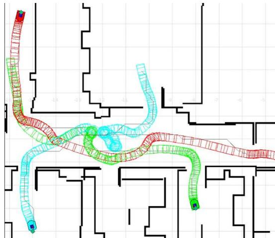
Slika 5.17. Putanje triju robota upravljanih izvornim objedinjenim algoritmom.
