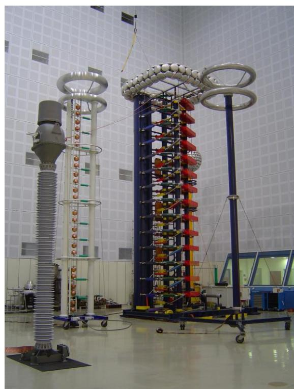
Slika 2.6 - Strujni transformator  $U_m = 420 \text{ kV}$ , ispitivanje udarnim naponima
