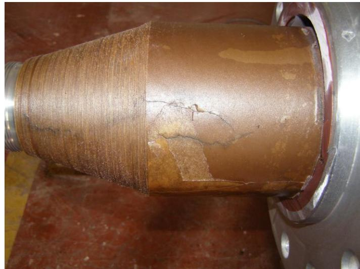
*Slika 4.5 – Klizni probaj po papirnoj izolaciji provodnika nakon uklanjanja epoksidnog izolatora*
