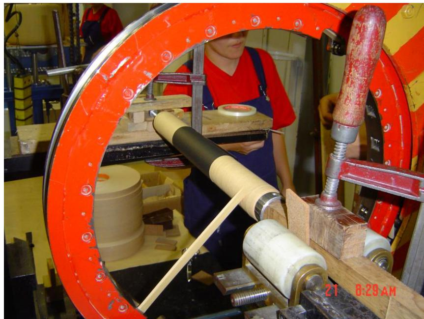
*Slika 3.3 - Namatanje modela izolacije mjernih transformatora*
