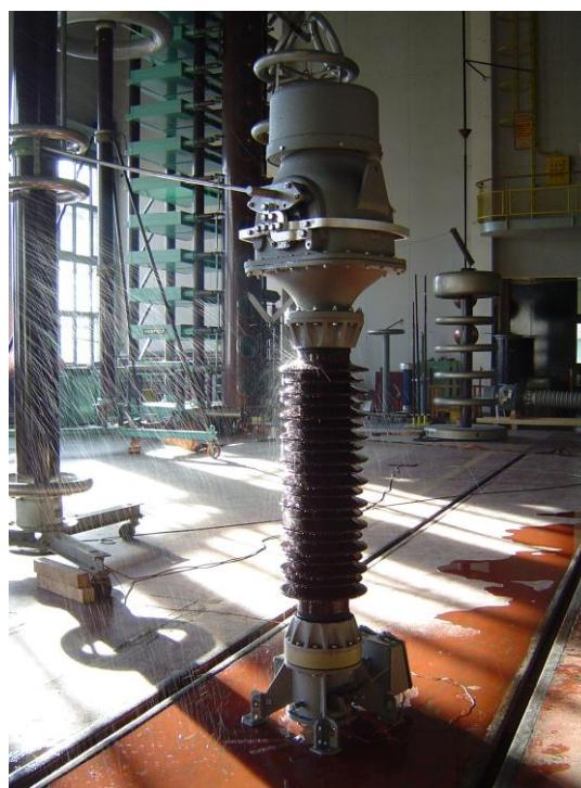
Slika 6.16 – Ispitivanje novog strujnog transformatora podnosivim naponom industrijske frekvencije na umjetnoj kiši
