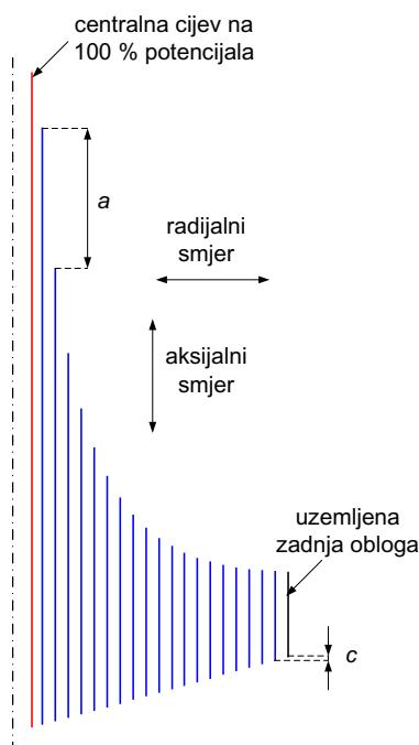
Slika 2.5 – Izolacijski sustav s parametrima obloga koji zadovoljavaju uvjet  $I \cdot r = \text{konst.}$
