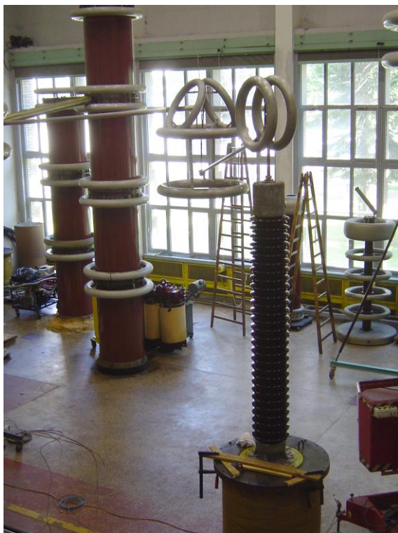
Slika 7.18 – Ispitivanje 245 kilovoltnog provodnika izmjeničnim naponom
