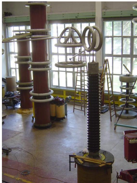
Slika 7.18 – Ispitivanje 245 kilovolttnog provodnika izmjeničnim naponom
