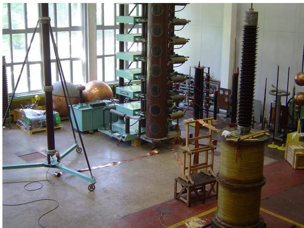
*Slika 7.17 – Ispitivanje 245 kilovoltnog provodnika udarnim naponima*
