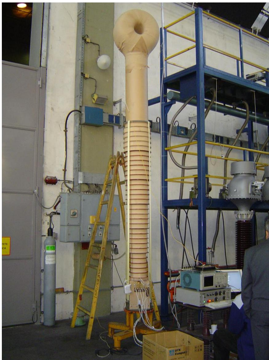
Slika 2.10 – Mjerjenje raspodjele udarnih napona duž izolacijskog sustava kombiniranog transformatora  $U_m=420$  kV prije impregnacije
