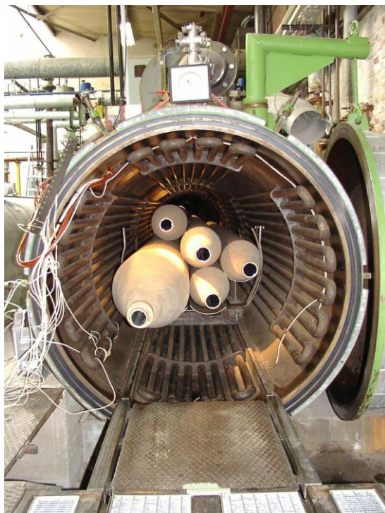
Slika 2.1 – Kondenzatorska tijela provodnika u peći za sušenje
