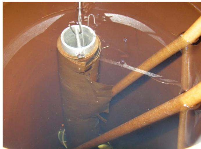
Slika 3.8 - Model br. 1 nakon proboga atmosferskim udarnim naponom
