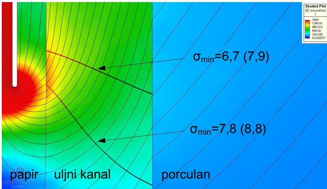
Slika 6.11 – Kritične linije polja i minimalni faktori sigurnosti u uljnom kanalu u blizini ruba zadnje obloge. Vrijednosti van zagrada odnose se na optimiranu inačicu, a vrijednosti u zgradama na postojeću inačicu.
