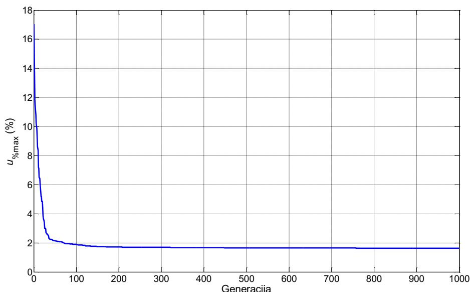
Slika 6.12 – Najveće postotno odstupanje maksimalnog pada napona od linearne raspodjele potencijala za najbolji sustav u svakoj generaciji
