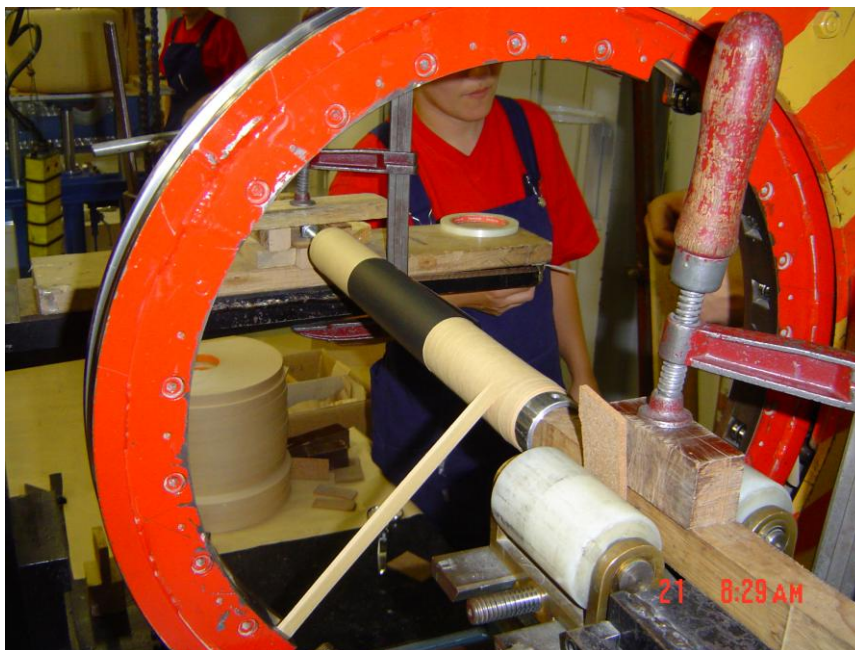
Slika 3.3 - Namatanje modela izolacije mjernih transformatora
