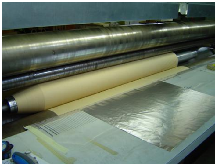
Slika 2.4 - Umetanje aluminijskih obloga za vrijeme namatanja
