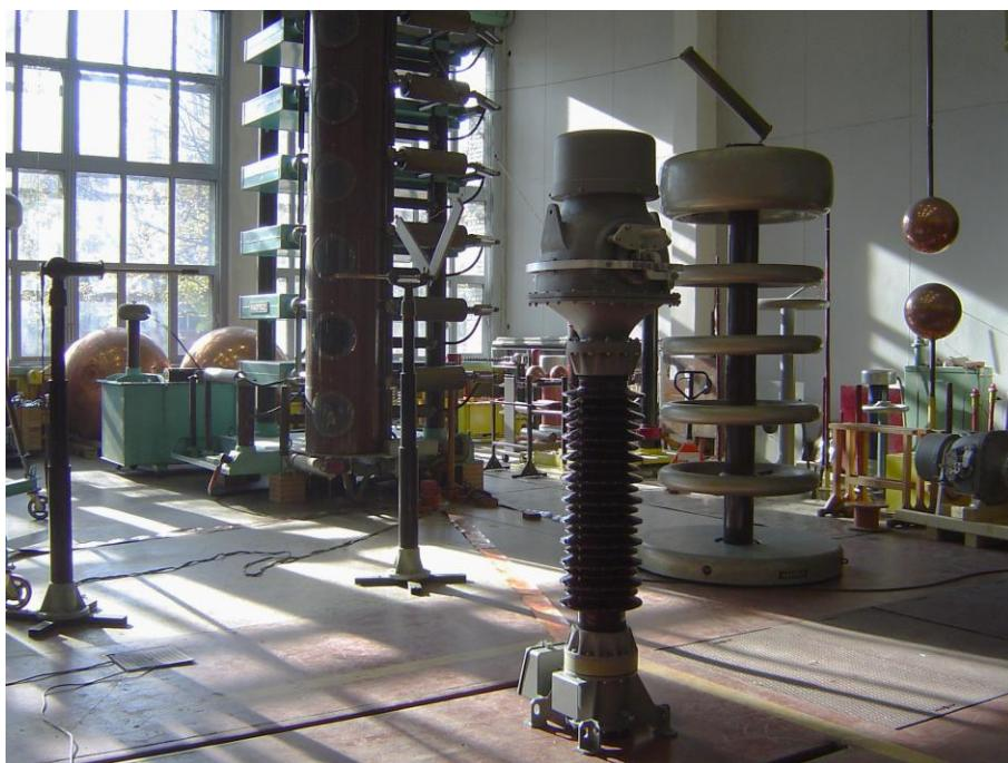
Slika 6.15 – Ispitivanje novog strujnog transformatora udarnim naponom
