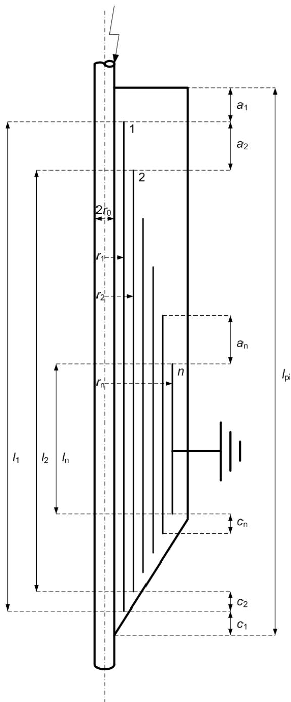
Slika 7.1 - Shematski prikaz kondenzatorskog tijela provodnika
