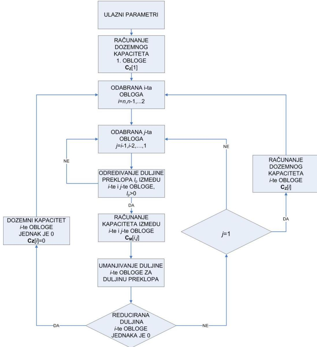
Slika 5.2 – Dijagram toka algoritma za proračun kapaciteta
