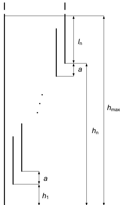
Slika 6.1 – Određivanje duljine zadnje obloge
