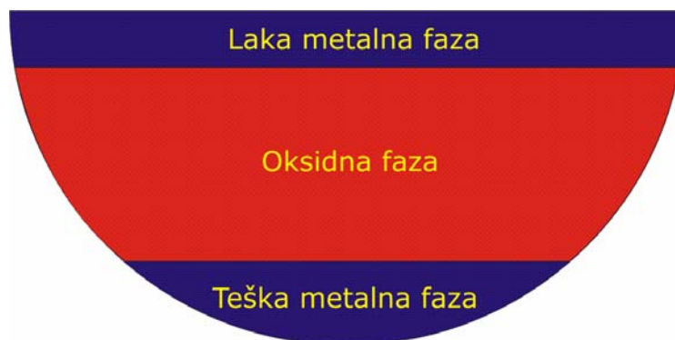
Slika 2-17: Inverzno uslojavanje rastaljenog materijala
