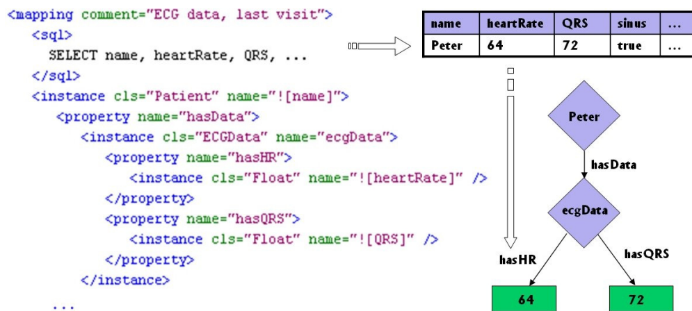
Slika 5.5. Prmjer formalizma koji preslikava podatke dohvaćene SQL upitom u strukturu definiranu ontologijom.
