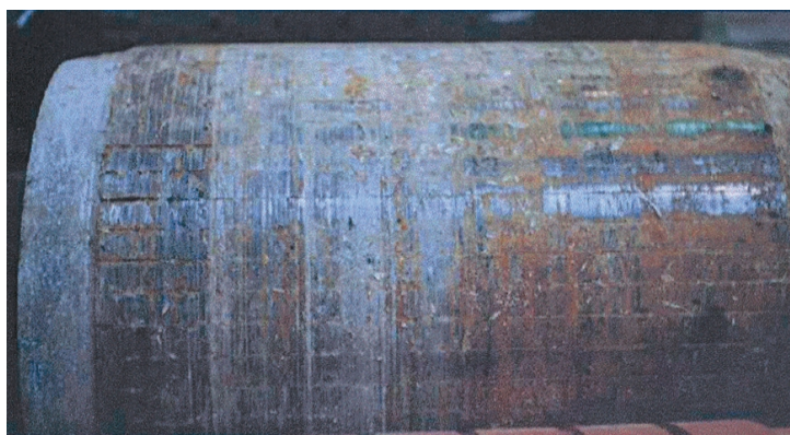
Slika E.2. Oštećenje lijevanog aluminijskog kaveza
