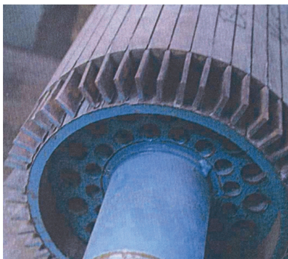
Slika E.3. Tipični kvar zbog loše izrade, erozija
