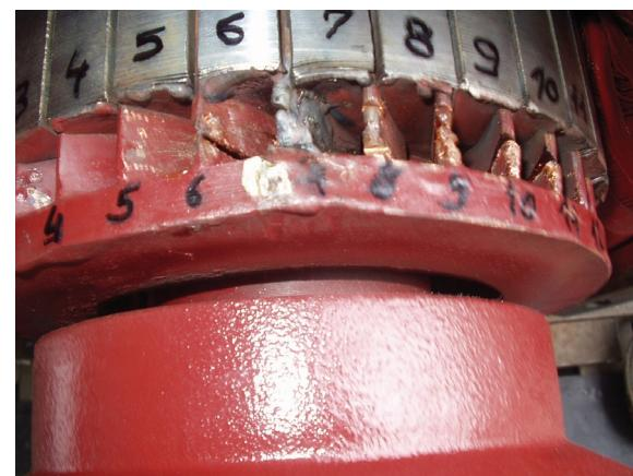
Slika G.5. Razina IV oštećenja kaveza rotora
