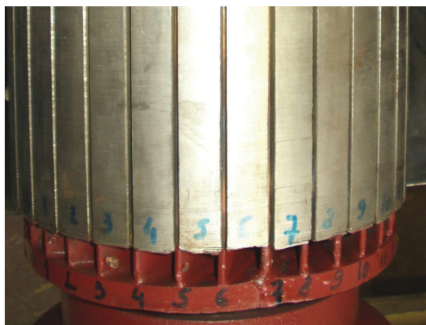
Slika G.1. Ispravan (servisiran) kavez rotora
