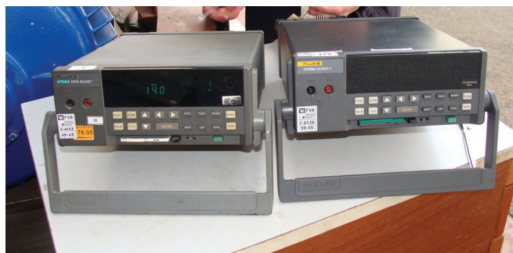
Slika 6.2. Ispitna oprema za mjerenje zagrijavanja elektromotora
