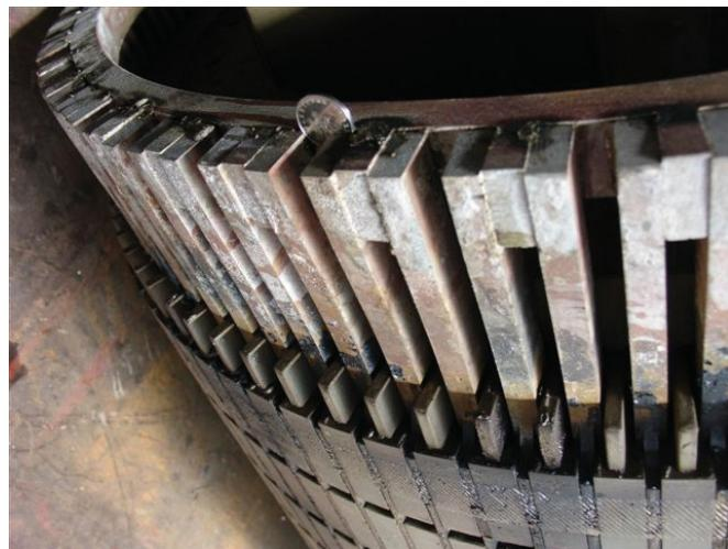
*Slika E.1. Oštećenje spoja štapova i prstena*
