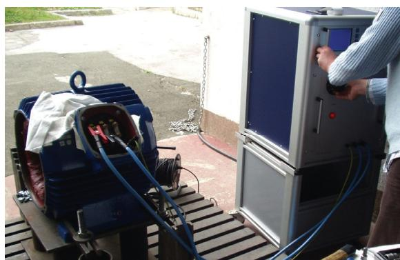
Slika 4.1. Mjerna oprema za ispitivanje dielektričke čvrstoće asinkronog „Ex e“ motora (380 V, 47 kW)
