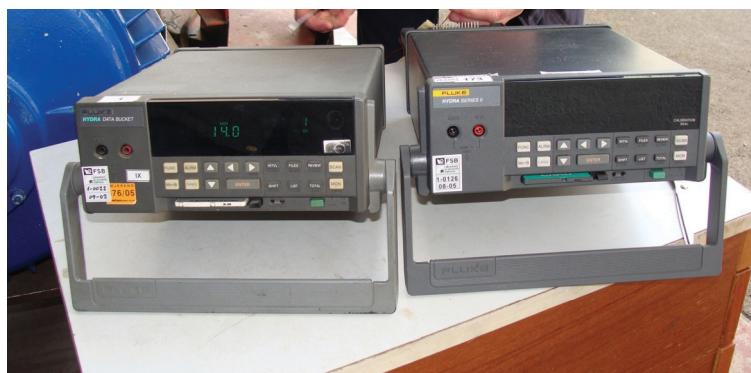
Slika 6.2. Ispitna oprema za mjerjenje zagrijavanja elektromotora
