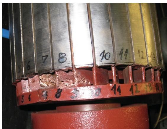
Slika G.4. Razina III oštećenja kaveza rotora
