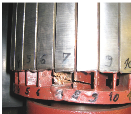
Slika G.3. Razina II oštećenja kaveza rotora
