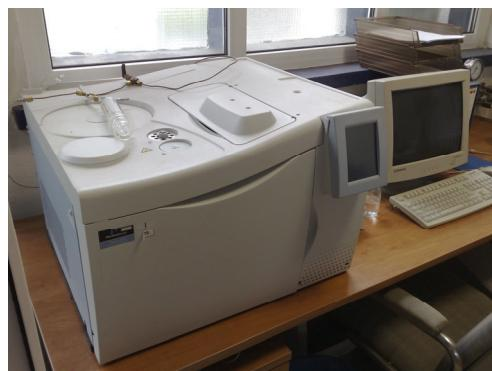
*Slika H.2. Kromatograf za kontrolu sastava eksplozivne smjese PERKIN ELMER*
