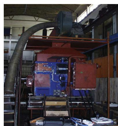
Slika A.4. „Ex ped IIB T3“ motor, 6,6 kV, 1,7 MW
