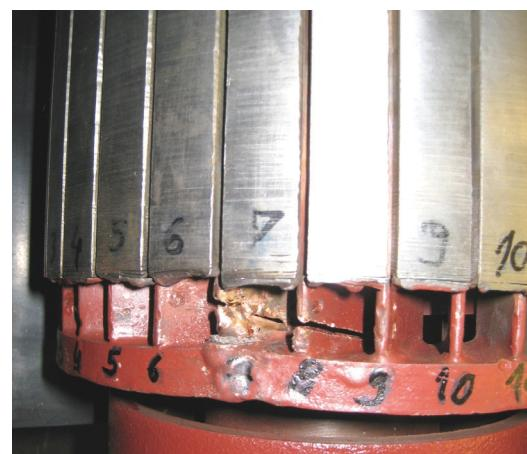
Slika G.3. Razina II oštećenja kaveza rotora
