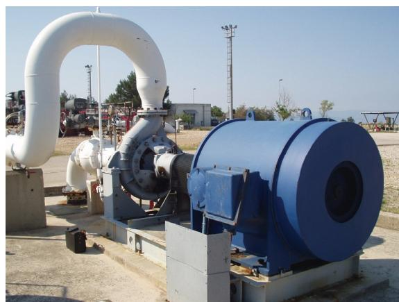
Slika A.3. „Ex de II A T3“ motor, 6 kV, 370 kW
