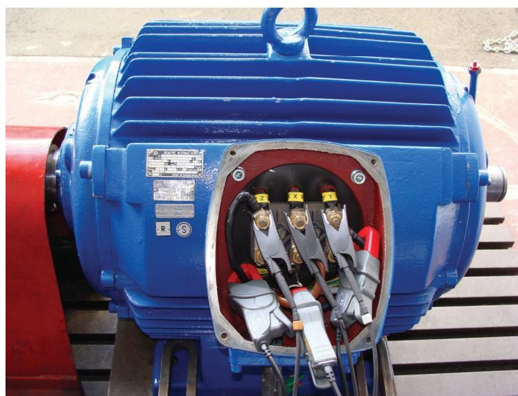
Slika B.1. Ispitivani „Ex e“ motor
