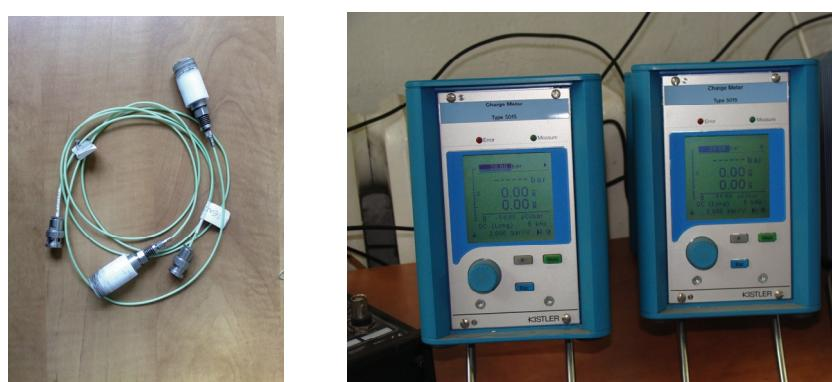
*Slika H.3. Davači (pretvornici) tlaka i sustav/uređaj za mjerjenje tlaka eksplozije KISTLER*
