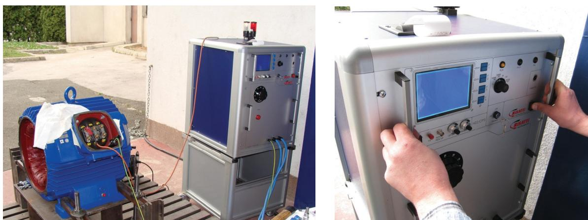
*Slika F.2. Ispitni uređaj za ispitivanje udarnim naponom Risatti H22/CPS*
