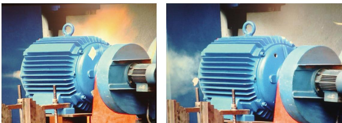
Slika 6.12. Eksplozija smjese acetilen/zrak izazvana kvarom kaveza rotora
