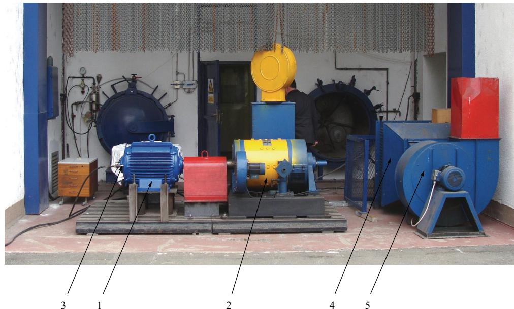
*Slika 6.1. Ispitni sustav za ispitivanje elektromotora
