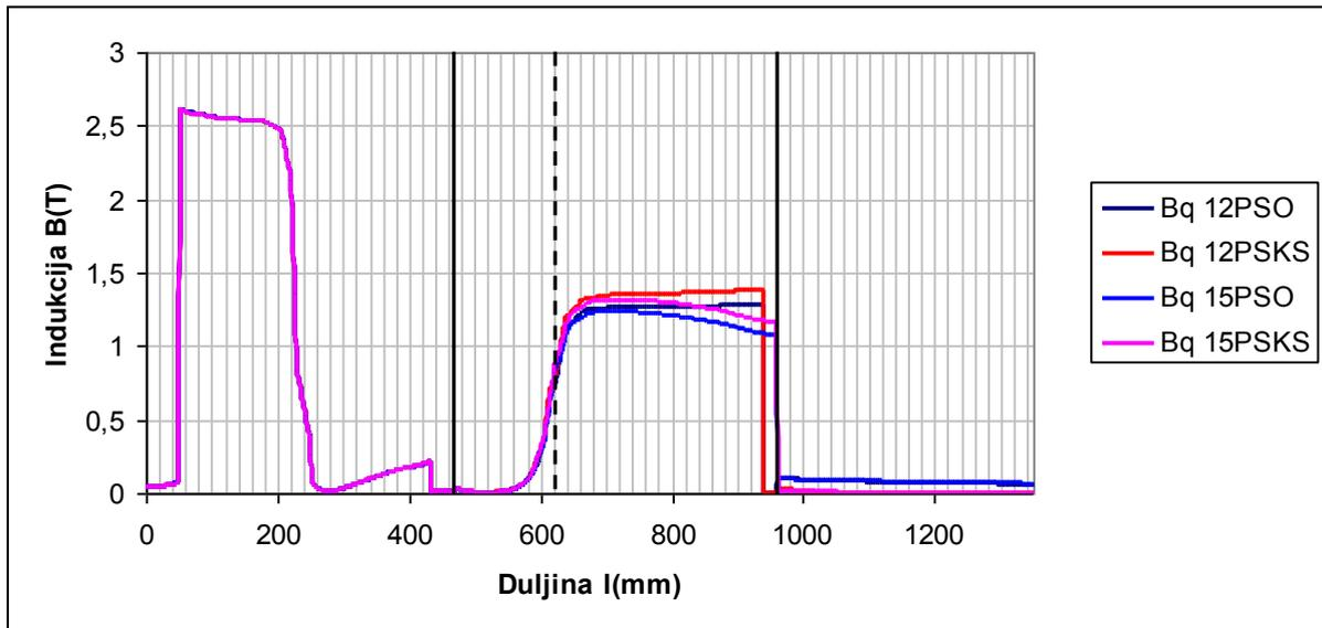
Slika 5.12 Indukcija u  $q$  osi po presjeku generatora od centra rotora do vanjskog promjera kućišta za generator s 12 štapova prigušnog namota statora i generator s 15 štapova prigušnog namota statora ( $I_u = 226$  A;  $t = 60$  ms).
