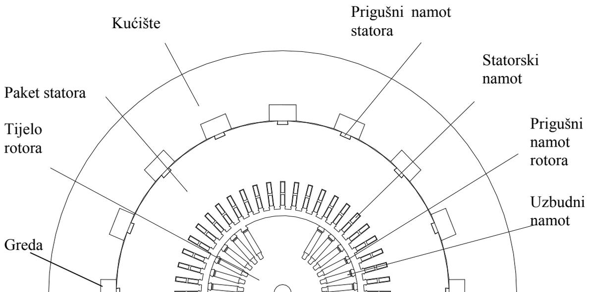
**Slika 4.1** Presjek jednog dvopolnog turbogeneratora i elementi korišteni za izračun 2D elektromagnetskog polja
