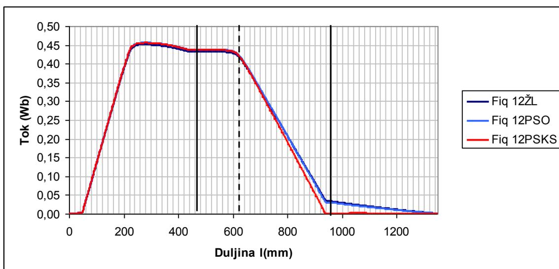
Slika 5.11 Tok u  $q$  osi po presjeku generatora od centra rotora do vanjskog promjera kućišta generatora s 12 štapova prigušnog namota statora ( $I_u = 226$  A;  $t = 60$  ms).
