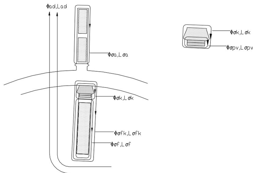
**Slika 3.2** Glavni i rasipni tokovi i induktiviteti namota generatora u blizini zračnog raspora:
