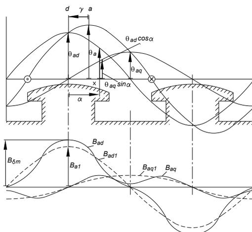
**Slika 2.12** Protjecanje i magnetsko polje u  $d$  i  $q$  osi stvoreno strujom faze namotaja statora: a) raspodjela protjecanja u prostoru; b) vektorski prikaz protjecanja (magnetomotorne sile), c) raspodjela indukcije i osnovni harmonik indukcije u  $d$  i  $q$  osi.
