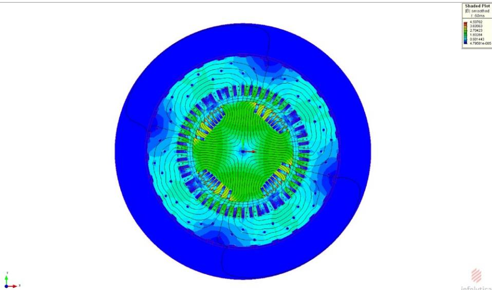
Slika 6.19 Polje četveropolnog generatora s otvorenim prigušnim namotom statora u nazivnoj radnoj točki ( $I_{un}=7895$  A,  $t=60$  ms)
