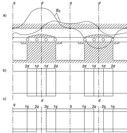
**Slika 2.7** Shema razdijeljenog prigušnog namota i njegovo djelovanje: a) gustoća magnetskog polja u zračnom rasporedu nepomično prema osima  $d$  i  $q$ ; b) krugovi prigušnog namotaja  $d$  osi; c) krugovi prigušnog namotaja  $q$  osi.
