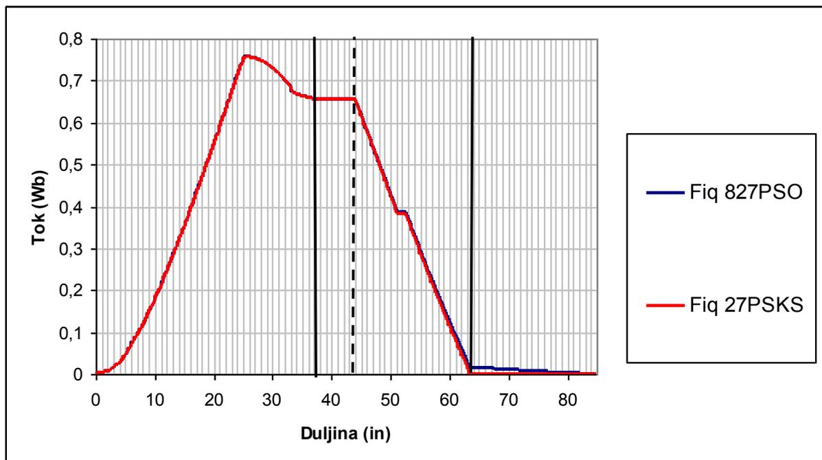
Slika 5.44 Tok u  $q$  osi po presjeku generatora od centra rotora do vanjskog promjera kućišta generatora s 27 štapova prigušnog namota statora ( $I_u = 3375$  A) – originalna konstrukcija s aksijalnim kanalima.
