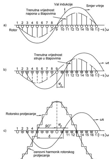
Slika 2.5 Reakcija kaveznog rotora u dvopolnom polju.
