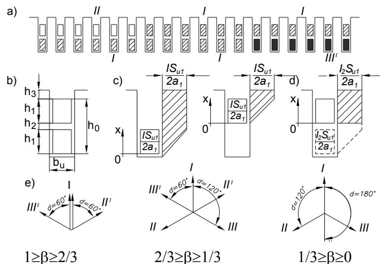
Slika 2.23 a) Prikaz rasporeda faznih vodiča dvoslojnog statorskog namotaja s korakom skraćivanja  $\beta=2/3$ ,  $q=12$ , b) Skica utora s veličinama preko kojih se računa utorsko rasipanje; c) Izračun samoinduktiviteta namota; d) Izračun međuinuktiviteta namota; e) Kutovi struja u utoru kod različitog skraćivanja koraka.
