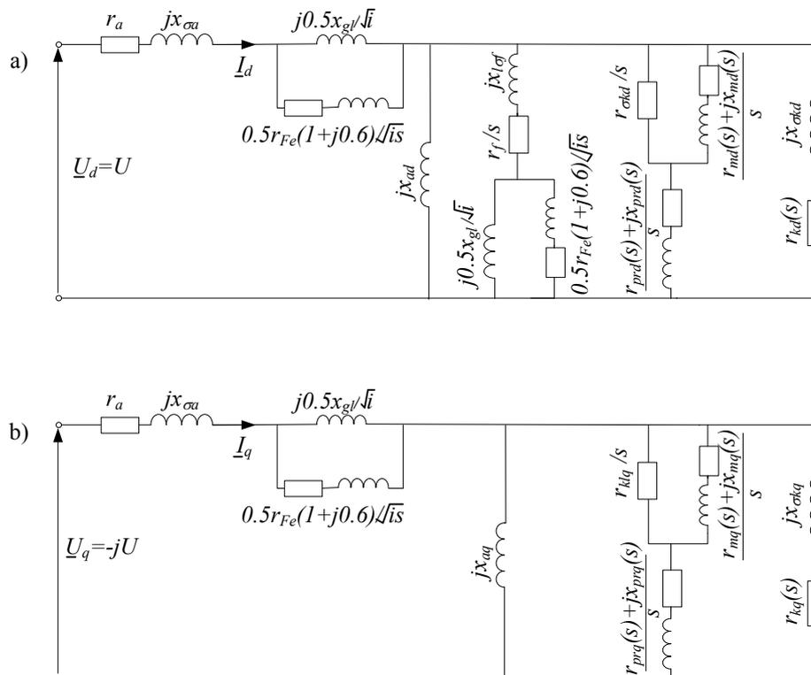
**Slika 3.3 Nadomjesna shema turbogeneratora u asinkronom režimu rada a) d osi, b) q osi.**
