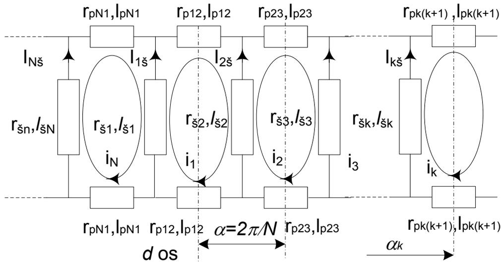
**Slika 3.1** Mreža ekvivalentnih impedancija prigušnog namota, gdje su:  $r_{pk(k+1)}$  i  $l_{pk(k+1)}$  - otpor i rasipni inuktivitet kratkospojnog prstena;  $r_{š}$  i  $l_{š}$  - otpor i rasipni inuktivitet štapa prigušnog namota;  $i_1$ – $i_N$  struje strujnih krugova za  $N$  štapa prigušnog namota;  $\alpha_k = k \cdot \alpha$  - kut od simetrale pola do simetrale  $k$ -tog strujnog kruga.
