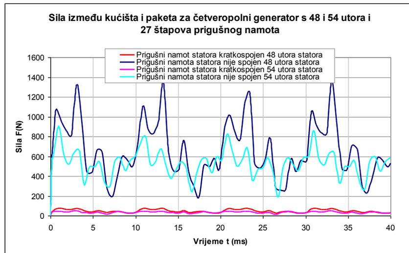
Slika 6.6 Sila između kućišta i paketa za četveropolni generator u vremenskoj domeni.
