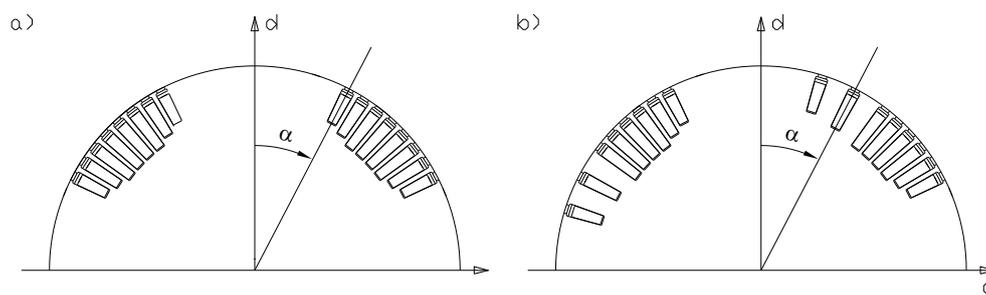
**Slika 2.3 Rotor turbogenerators: a) simetrični rotor četverpolnog turbogenerators; b) asimetrični rotor četverpolnog turbogenerators.**
