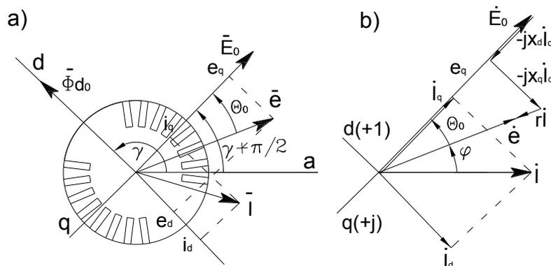
Slika 2.16 Vektorski dijagram sinkronog stroja za stacionarni režim rada a) dijagram koji opisuje položaj vektora; b) dijagram u kompleksnoj ravnini.
