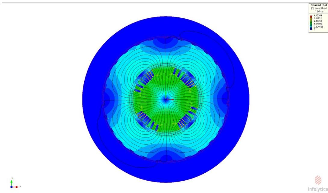
Slika 5.22 Polje četveropolnog generatora s asimetričnim rotorom, bez statorskih utora i 24 štapa prigušnog namota koji su kratko spojeni ( $I_u = 3375$  A;  $t = 60$  ms).
