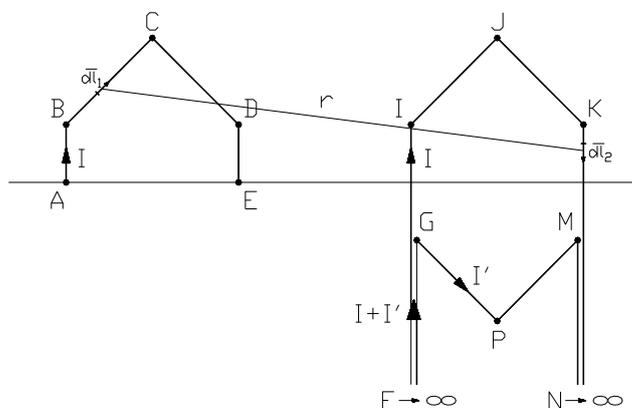
Slika 2.25 Principni model glava namota za proračun međuinduktiviteta.
