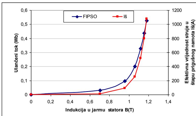
Slika 5.47 Funkcija ulančenog toka u otvorenom i struje u kratko spojenom prigušnom namotu statora ovisno o srednjoj vrijednosti indukcije na sredini jarmu statora.
