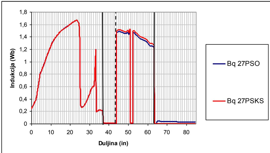
Slika 5.43 Indukcija i  $q$  osi po presjeku generatora od centra rotora do vanjskog promjera kućišta generatora s 27 štapova prigušnog namota statora ( $I_u = 3375$  A)– originalna konstrukcija s aksijalnim kanalima.
