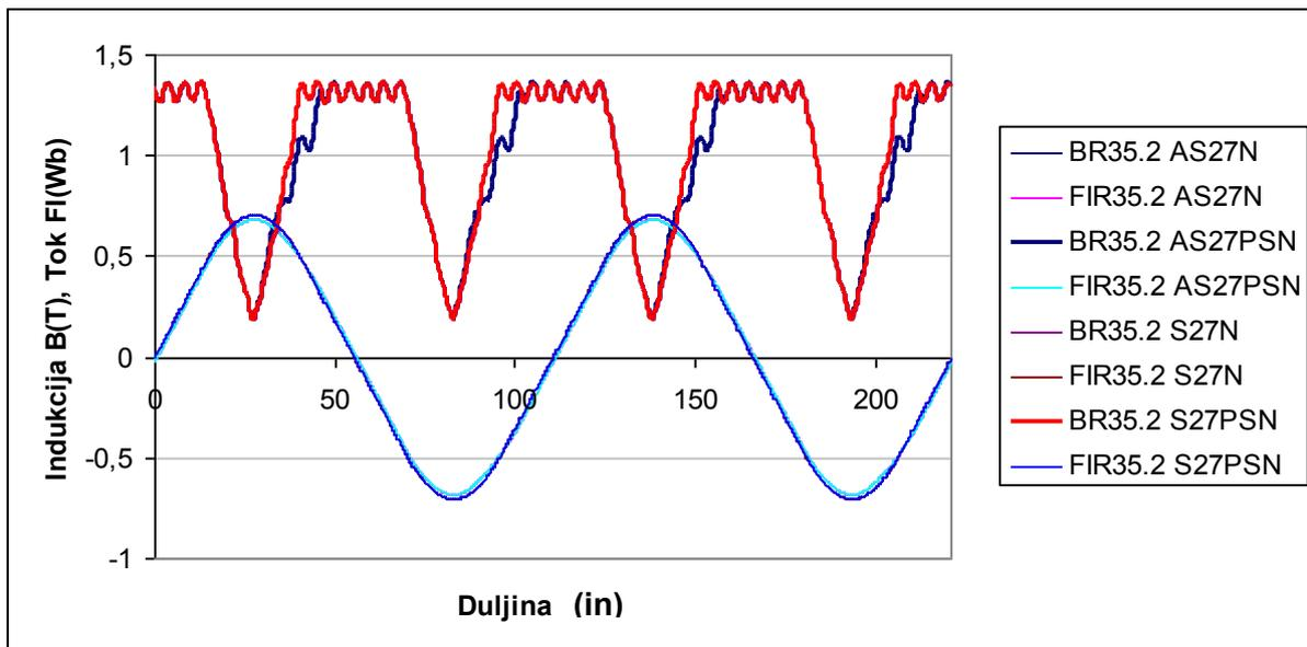
Slika 5.33 Prostorna raspodjela indukcije i toka na srednjoj liniji zračnog raspora u praznom hodu ( $I_u = 3375$  A) za modele s asimetričnim (AS) i simetričnim (S) rotorom i prigušnim namotom koji je otvoren i kratko spojen.
