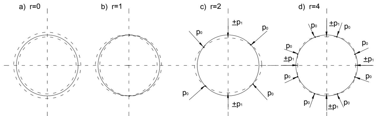
**Slika 6.3**      **Forme vibriranja električnih strojeva**
