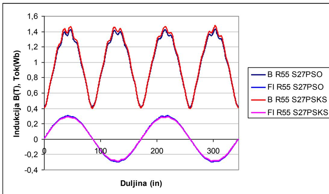
Slika 5.34 Indukcija i tokovi u jarmu statora za simetrični (S) rotor, za kavez s 27 štapova, ( $I_u = 3375$  A;  $t = 60$ ms), za kratko spojeni i otvoreni prigušni namot.
