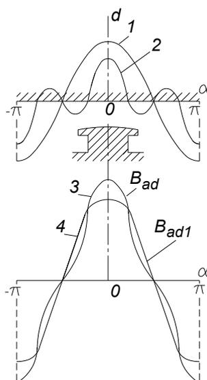
**Slika 2.4 Raspodjela gustoće magnetskog polja u zračnom rasporu u  $d$  osi stvorenog protjecanjem statorskog namota: 1. polje ovisno o vodljivosti  $\lambda_0$  2. polje ovisno o drugom članu vodljivosti  $\lambda_2 \cos 2\alpha$ ; 3 - rezultatno polje u  $d$  osi  $B_{ad}$ ; 4 - osnovni harmonik polja  $B_{ad1}$ .**
