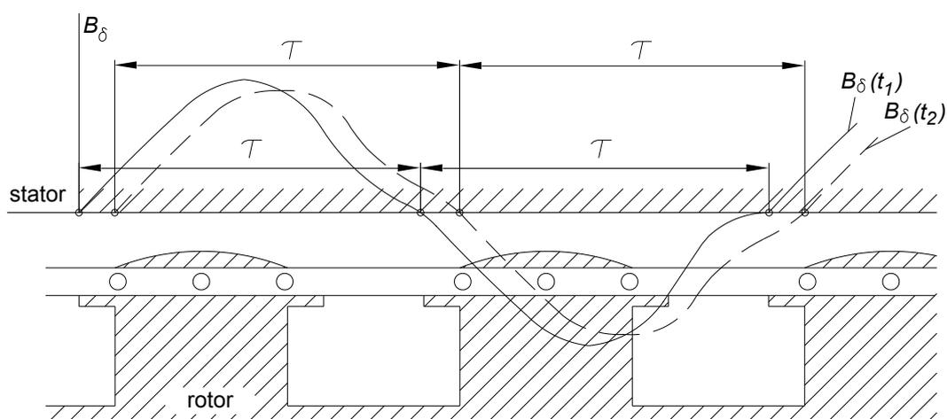
**Slika 2.6** Međusobni položaj gustoće magnetskog polja u zračnom rasporu i prigušnog namota u dva trenutka  $t_1$  i  $t_2$ .  $B_\delta(t_1)$  – raspodjela indukcije u zračnom rasporu duž provrta statora u trenutku  $t_1$ ;  $B_\delta(t_2)$  – raspodjela indukcije u zračnom rasporu duž provrta statora u trenutku  $t_2$ .
