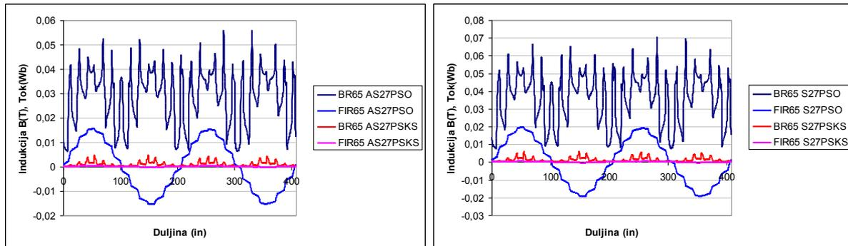
**Slika 5.35** Prostorna raspodjela indukcije i toka na unutarnjem promjeru kućišta za asimetričani i simetričan rotor, kavez s 27 štapova prigušnog namota ( $I_u = 3375$  A;  $t = 60$  ms).
