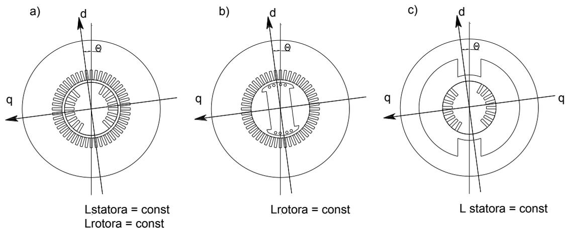
**Slika 2.11** Prikaz različitih geometrija statora i rotora i ovisnost promjene induktiviteta uz pretpostavku glatkih statora i rotora: a) stroj sa cilindričnim rotorom; b) stroj s istaknutim polovima na rotoru; c) stroj s istaknutim polovima statora.
