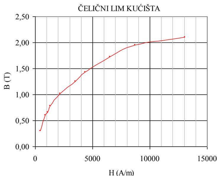
**Slika 4.6 Ispitana krivulja magnetiziranja čeličnog lima kućišta statora.**
