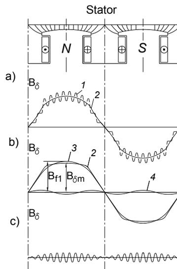
**Slika 2.2** Raspodjela gustoće magnetskog toka u zračnom rasporu duž provrta statora kada je  $B_\delta$  inducirana strujama uzbuđenog namota: a) oblik krivulje gustoće toka 1 – kada se uzme u obzir izobličenje zbog nazubljenosti statora; 2 - bez utjecaja utora statora. b) prostorna harmonijska raspodjela 3-osnovni harmonik; 4- treći harmonik. c) utjecaj utora statora na gustoću magnetskog polja u zračnom rasporu.
