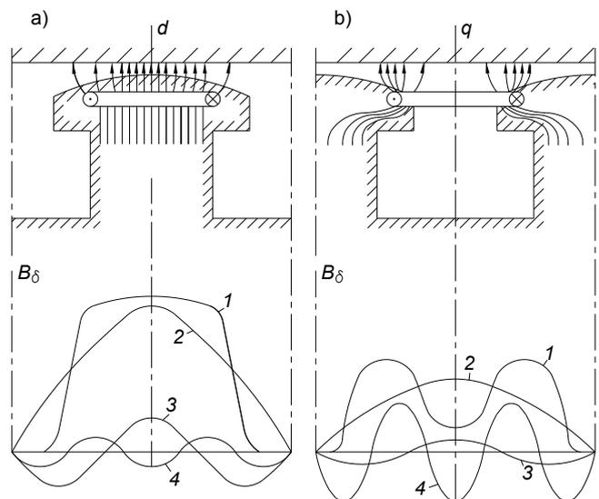
**Slika 2.8** Magnetsko polje stvoreno strujama prigušnog namotaja  $d$  i  $q$  osi. 1-oblik prostornog vala indukcije; 2, 3, 4 – osnovni, treći i peti harmonik razložene krivulje indukcije u  $d$  i  $q$  osi.
