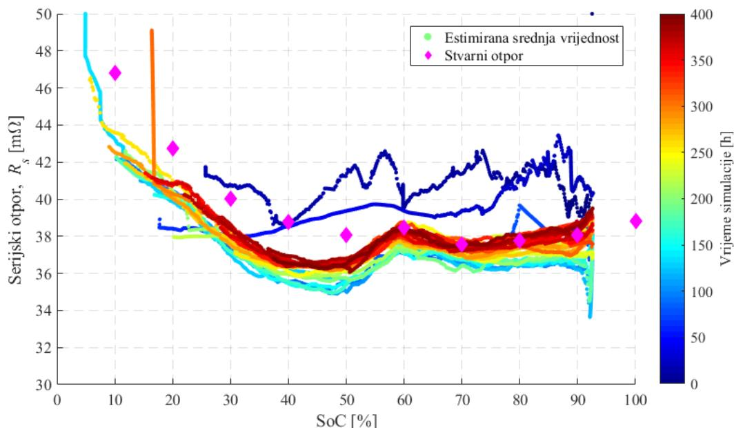
*Slika 7.9: Estimirane vrijednosti otpora  $R_s$  u funkciji estimiranog SoC-a, obojane s obzirom na vrijeme simulacije tj. vrijeme starenja, te uspoređene s stvarnim vrijednostima otpora identificiranim simulacijom EIS postupka u poglavlju 3.*
