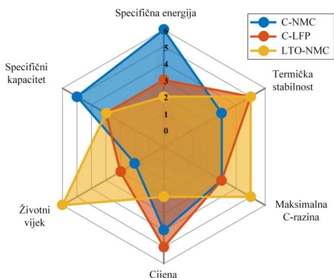
Slika 2.3: Usporedni radarski prikaz karakteristika ćelija triju najčešćih tipova litij-ionskih ćelija (priređen temeljem podataka iz [60]).
