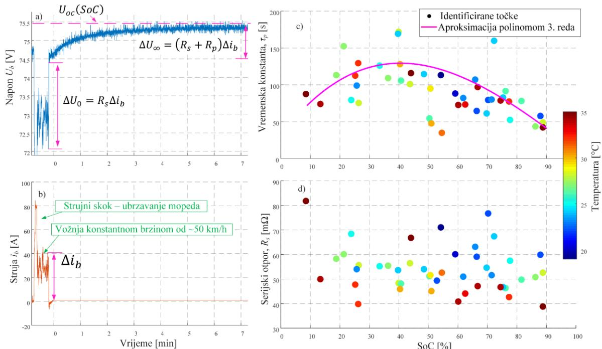
Slika 4.5: Odzivi a) napona i b) struje baterije tijekom relaksacijskog identifikacijskog eksperimenta, te rezultati identifikacije c) polarizacijske vremenske konstante  $\tau_p$  i d) serijskog otpora  $R_s$ .
