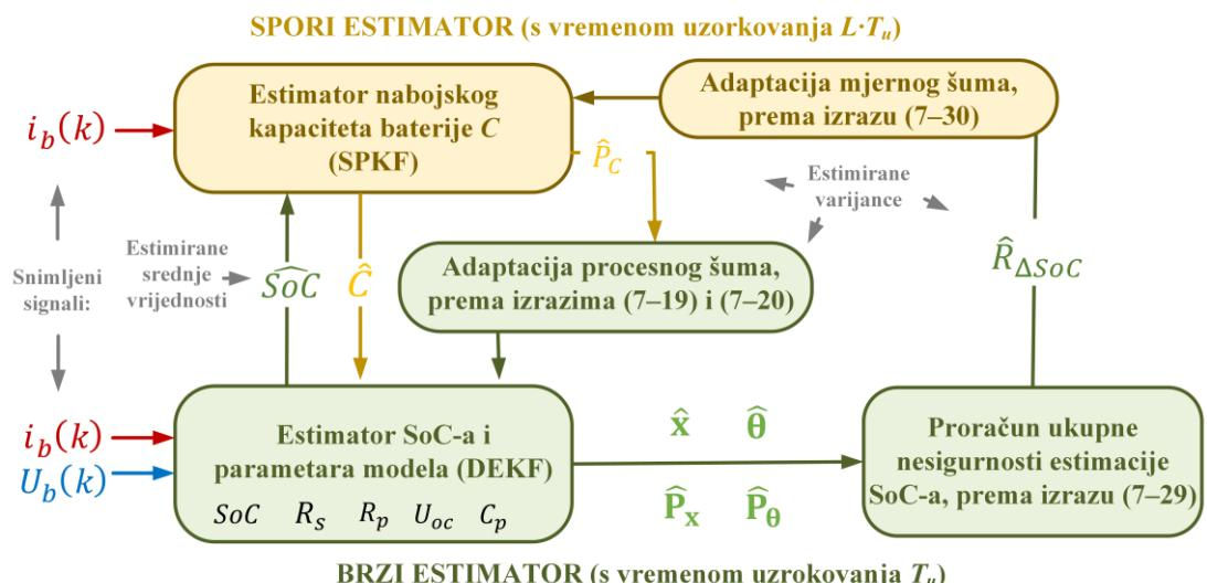
Slika 7.2: Blokovski prikaz ukupnog algoritma estimacije uključujući adaptivne sprege između pojedinačnih estimatora izvršavanih s različitim vremenskim skalama.
