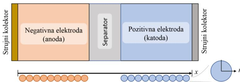
Slika 4.7: Ilustracija pseudo2D modela ćelije korištenog u GT-AutoLion simulacijskom okruženju (preuzeto i adaptirano iz [11]).
