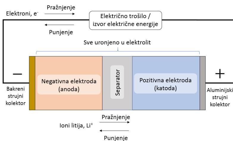
Slika 2.1: Opća ilustracija strukture litij-ionske ćelije.
