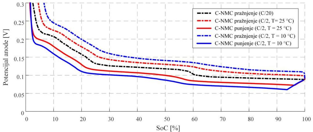
Slika 3.14: Potencijal anode C-NMC čelije za slučaj sporog pražnjenja (crna isprekidana linija) te brzog (C/2) pražnjenja i punjenja na temperaturi iznosa 25 °C (crvene linije) i 10 °C (plave linije).
