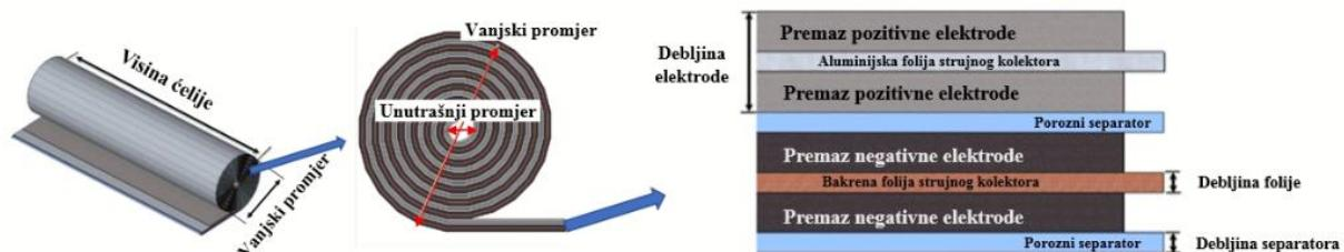
Slika 2.4: Ilustracija građe cilindrične čelije (preuzeto iz [55] i adaptirano).
