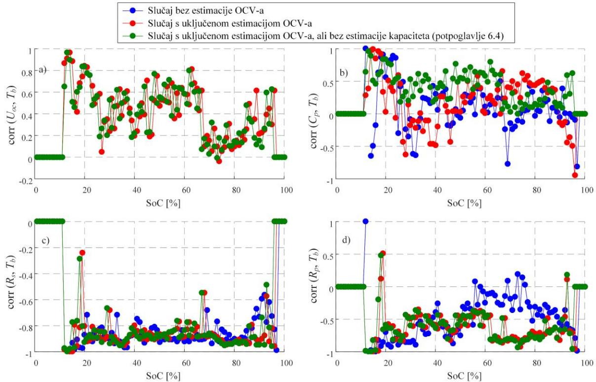
Slika 7.11: Koefficijenti temperaturne korelacije estimiranih vrijednosti a) OCV-a, b) polarizacijskog kapaciteta, c) serijskog otpora i d) polarizacijskog otpora, u slučaju ukupnog estimatora s dvije vremenske skale danog u tri varijante ovisno o uključenosti estimacije parametara OCV karakteristike i kapaciteta baterije.
