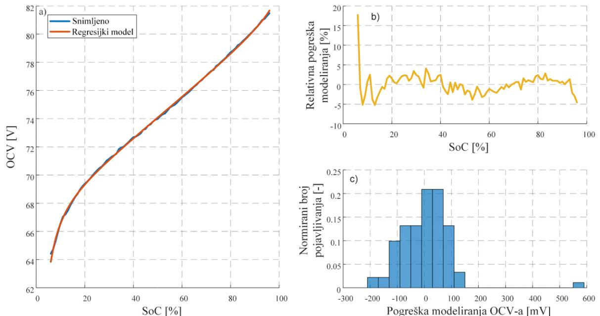
Slika 6.5: pogreška modeliranja  $U_{oc}(SoC)$  karakteristike baterije mopađa: a) prikaz snimljene i modelirane karakteristike, b) relativna pogreška modeliranja te c) histogram pogreški modeliranja.
