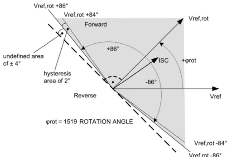
**Slika 8.18:** Područje „naprijed“ kod usmjerjenog elementa
