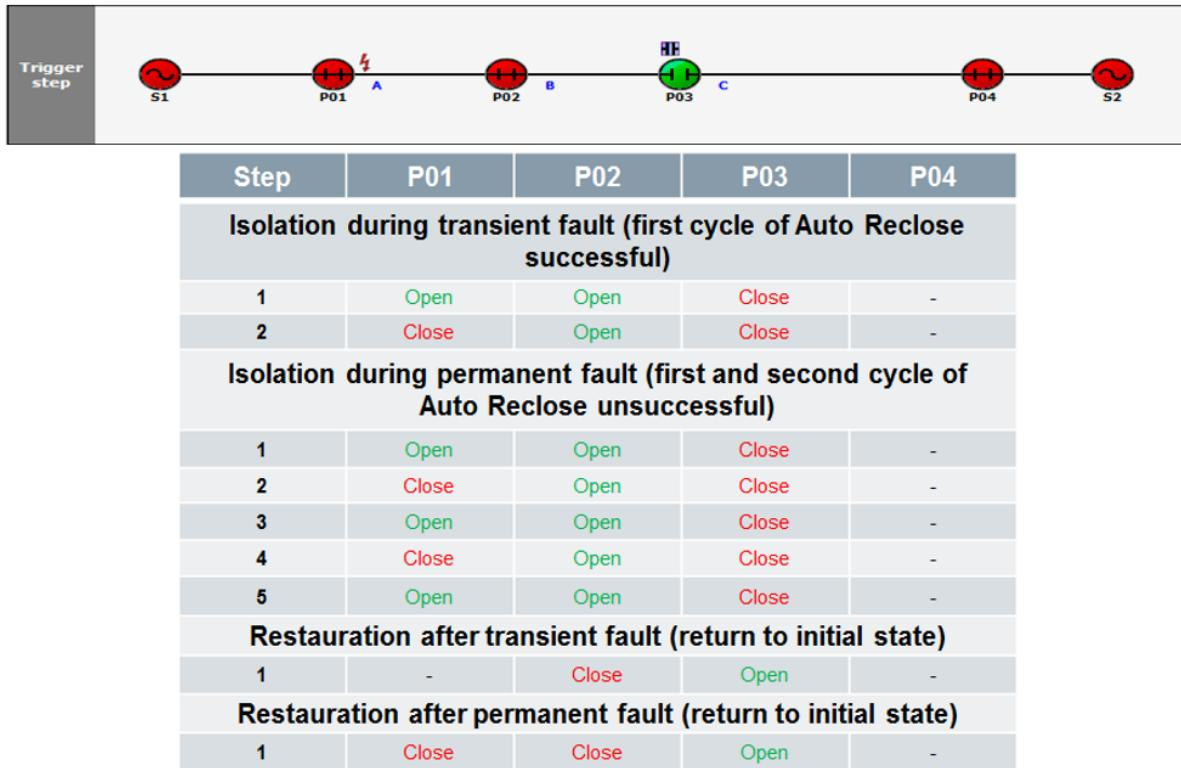
**Slika 8.13:** Matrica uklopnih stanja za pojedinu sekvencu
