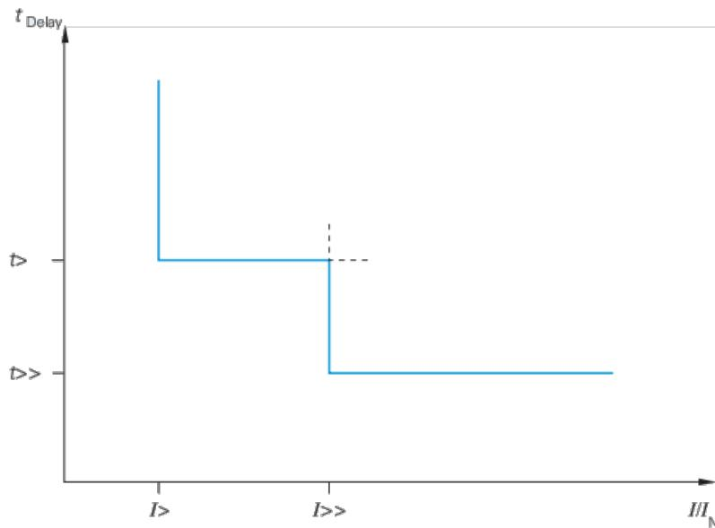
Slika 3.5: Nadstrujni relj s neovisnom vremenskom karakteristikom
