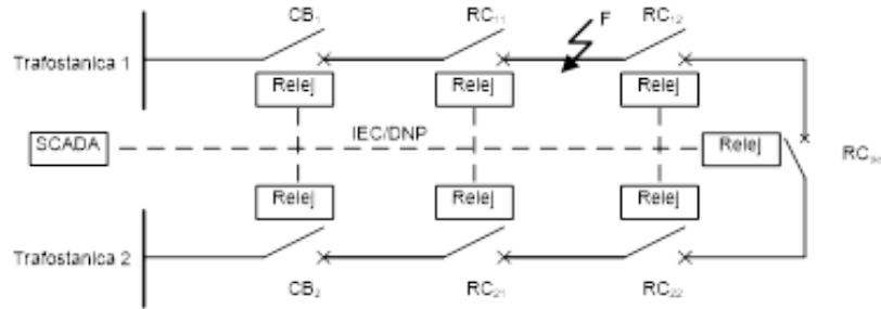
Slika 4.10: Nadzemna mreža sa komunikacijom sa SCADA sustavom
