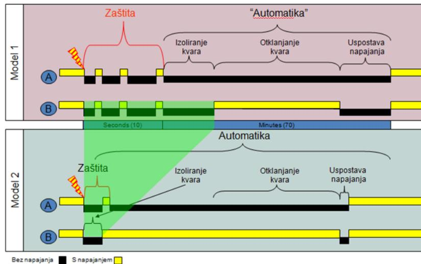
**Slika 4.9:** Usporedba vremena otklanjanja kvara
