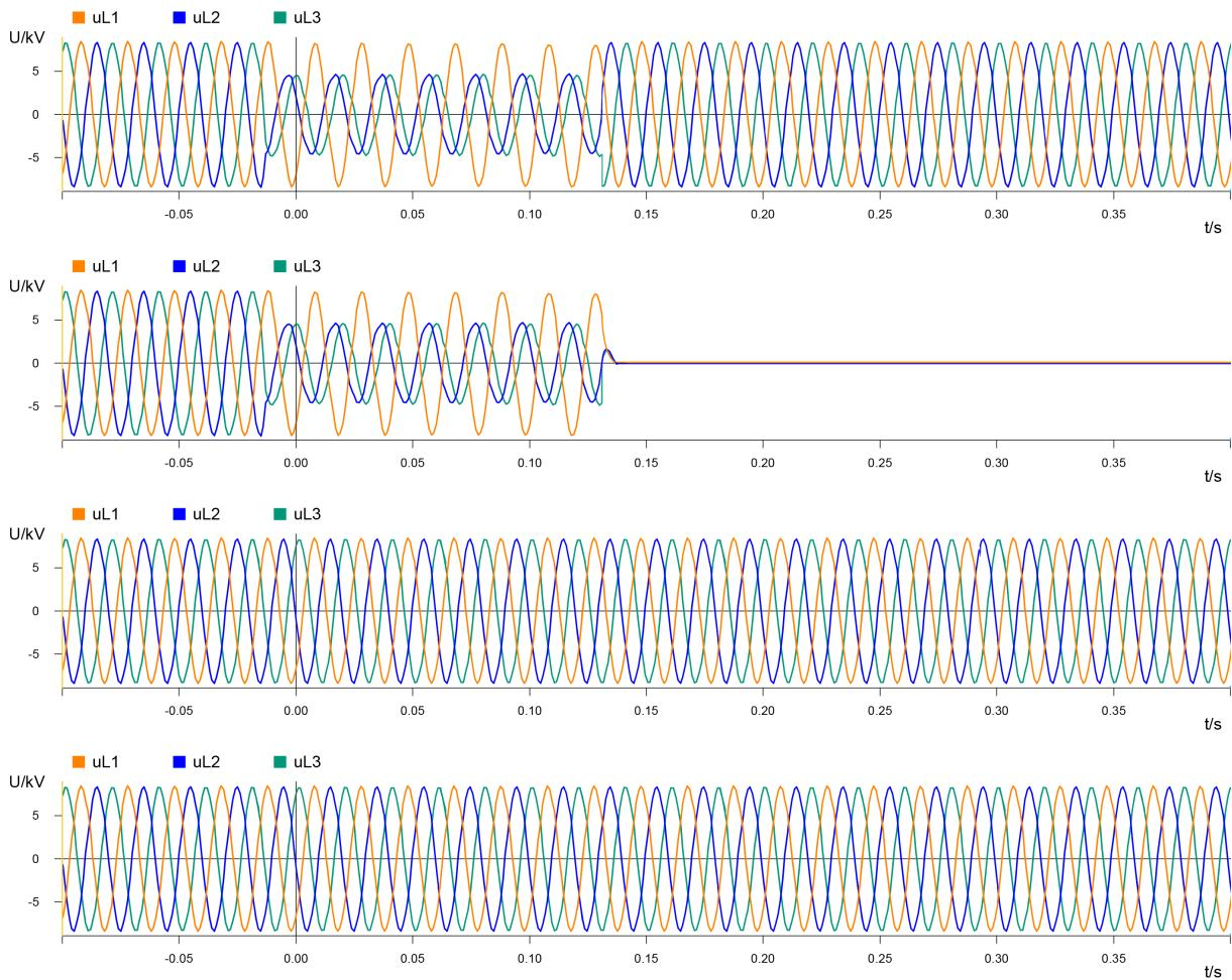
**Slika 8.8:** Oscilografski zapis napona sa releja RC1-RC4
