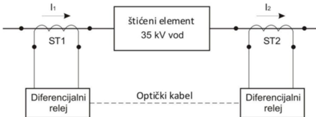
Slika 8.14: Shema uzdužne diferencijalne zaštite
