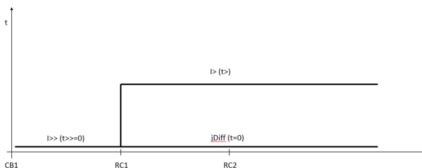
Slika 8.20: Koordinacija vremena isklona sa jDiff (komunikacija aktivna)
