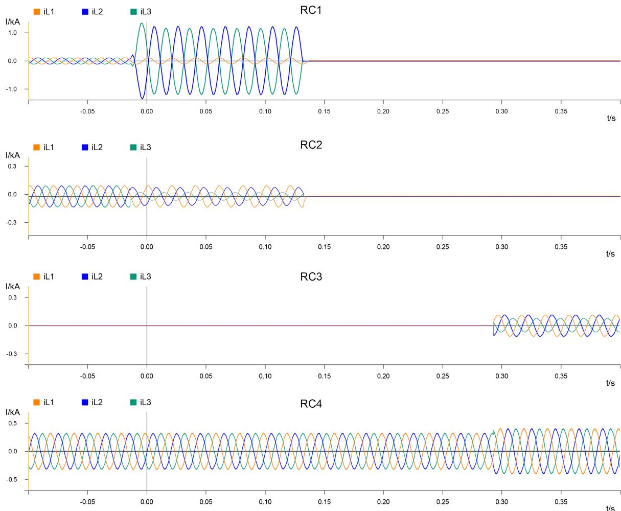
**Slika 8.7:** Oscilografski zapis struja sa releja RC1-RC4
