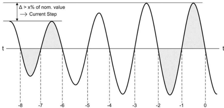
Slika 8.15: Uspoređivanje iznosa struja unutar zadnjih 3 ciklusa
