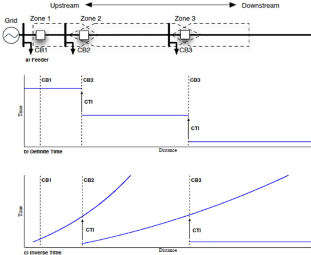
Slika 3.4: Zaštita radijalnog voda - zone i vremenska karakteristika
