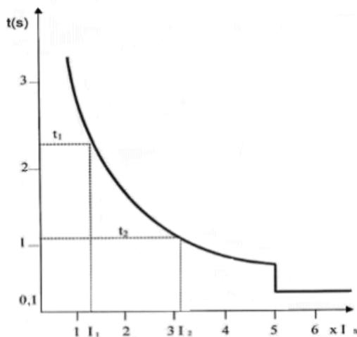
**Slika 3.8:** Kombinirana izvedba vremeni ovisnog i trenutnog nadstrujnog releja
