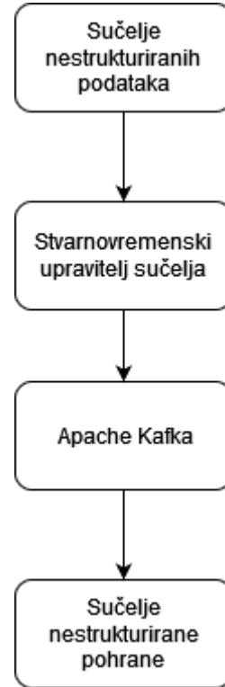
Slika 26. Arhitektura implementiranog gotovo stvarnovremenskog podatkovnog cjevovoda
