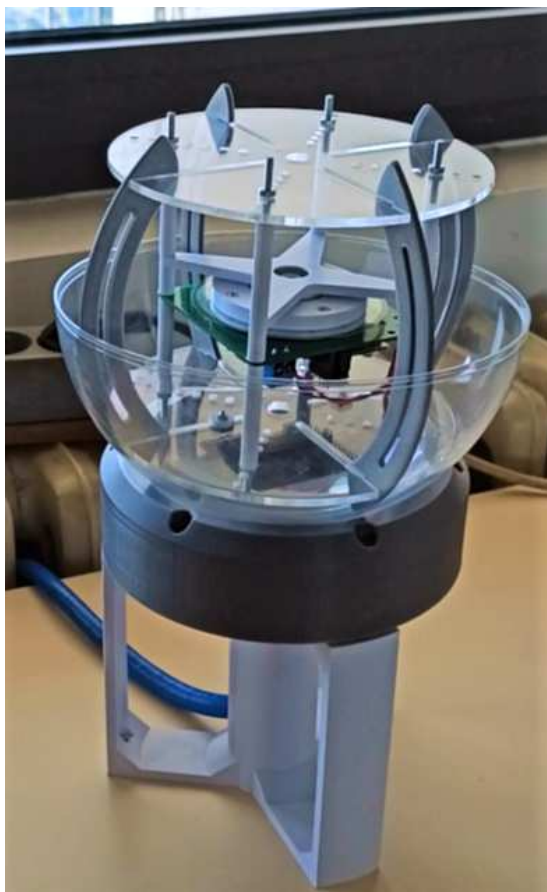
Slika 3.14: Prikaz ADCS sustava sa pripadajućim zračnim ležajem.
