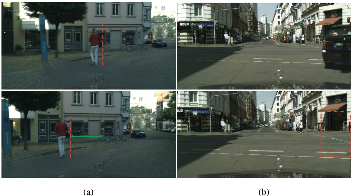
Slika 1.2: Ilustracija izazova prilikom gustog semantičkog prognoziranja na dvije scene iz skupa Cityscapes. Vremenski razmak između gornje i donje slike je 0.5 sekundi. Stupac (a) prikazuje mogućnost pojave velikih pomaka objekata u prostoru slike. Stupac (b) prikazuje mogućnost pojave novootkrivenih dijelova scene zbog pomaka objekata.
