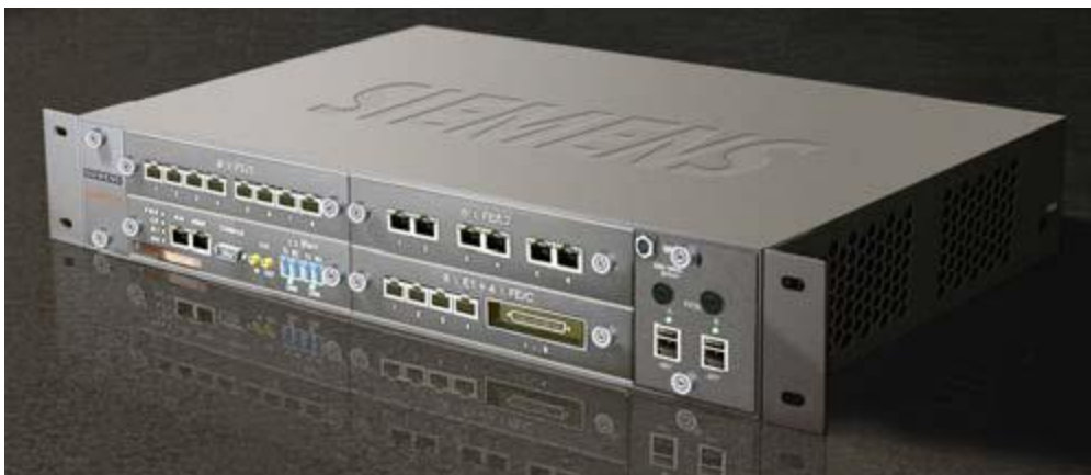
Slika 4.11. Sinkroni multipleksor Surpass hiT 7030 [6]
