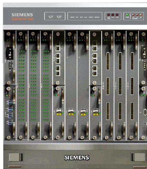
Slika 4.10. Sinkroni multipleksor Surpass hiT 7060 [6]
