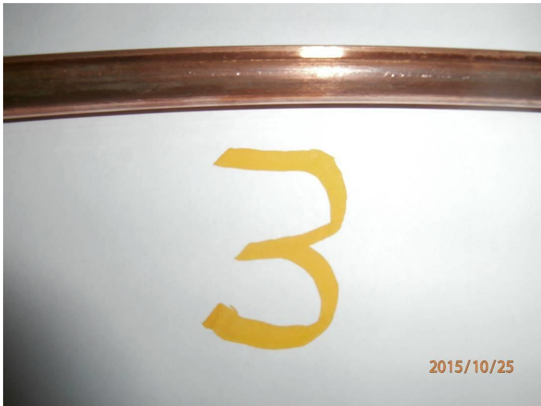
Slika 7.5. Uzorak 3 – Novi vodič
