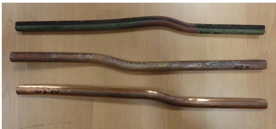
Slika 7.21. Uzorci nakon ispitivanja previjanjem
