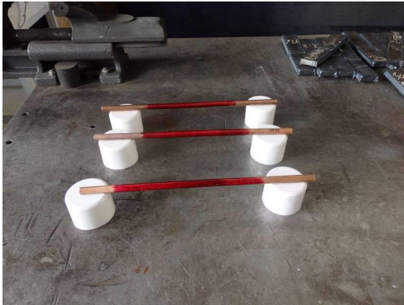
Slika 7.22. Uzorci na koje je nanesen penetrant
