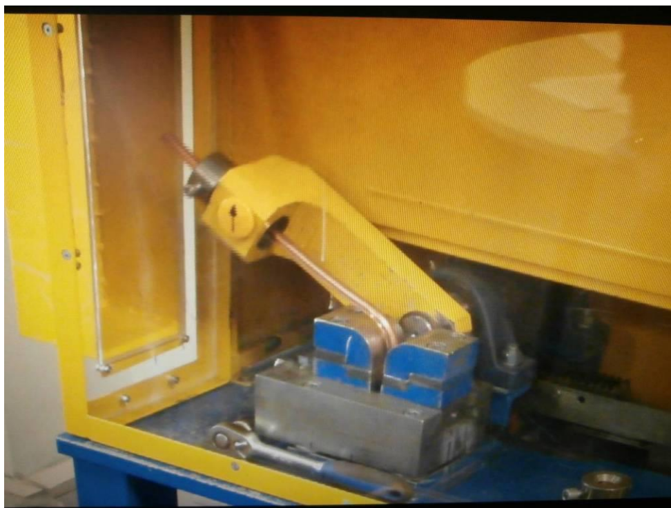
Slika 4.3. Ispitivanje na izmjenično savijanje
