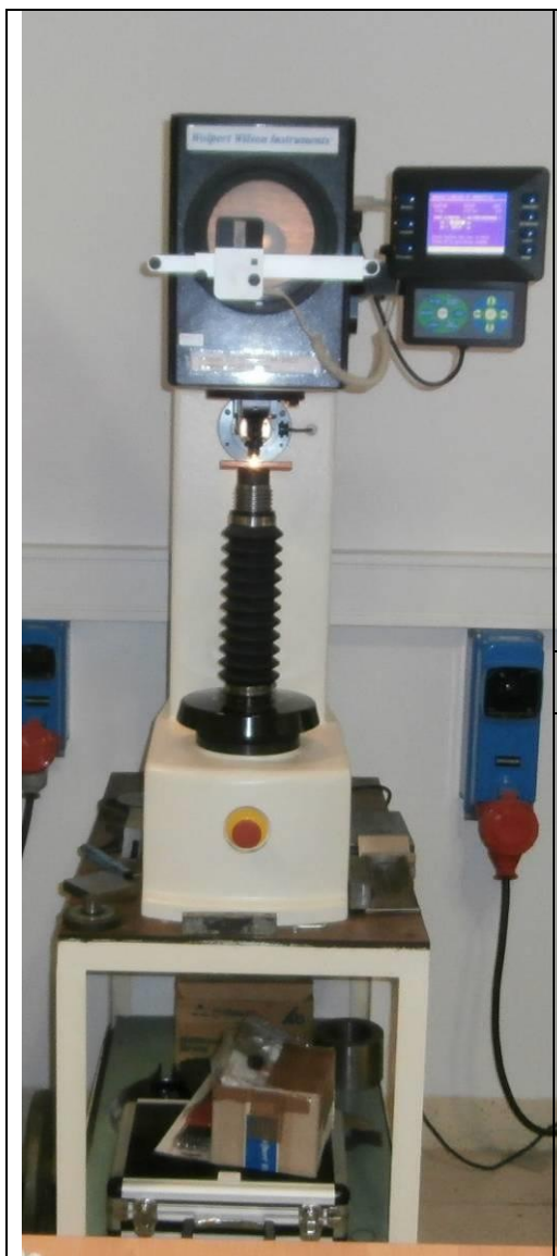
Slika 7.18. Mjerenje tvrdoće površine
