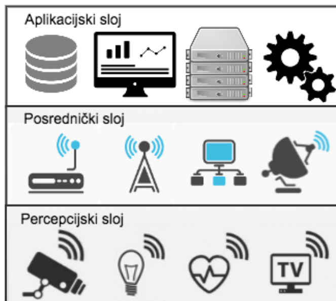
Slika 3.1: Osnovni arhitekturni model korišten u implementacijama primjena Interneta stvari.
