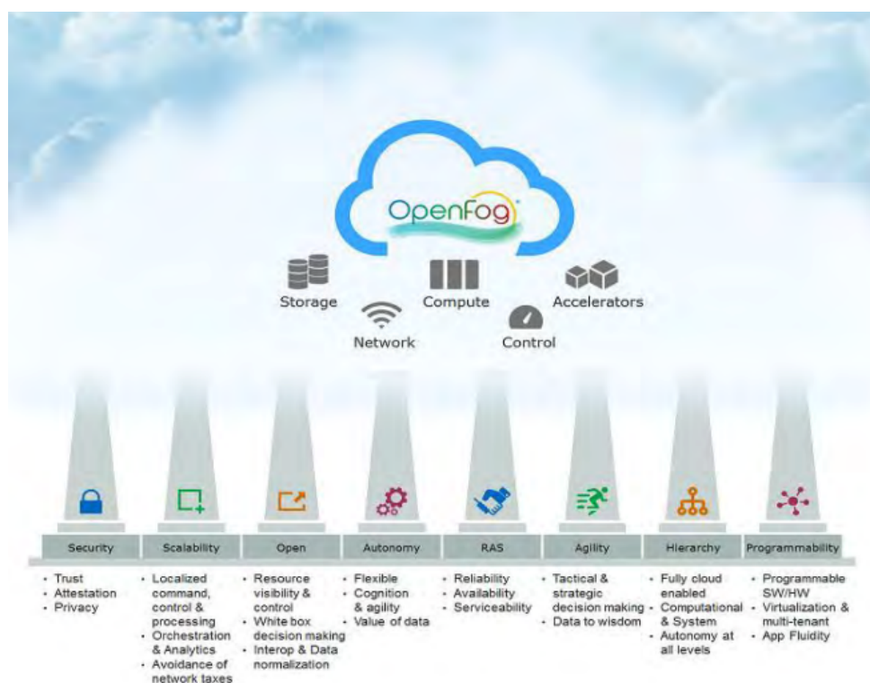
Slika 1.2: Stupovi OpenFogove referentne arhitekture [19].
