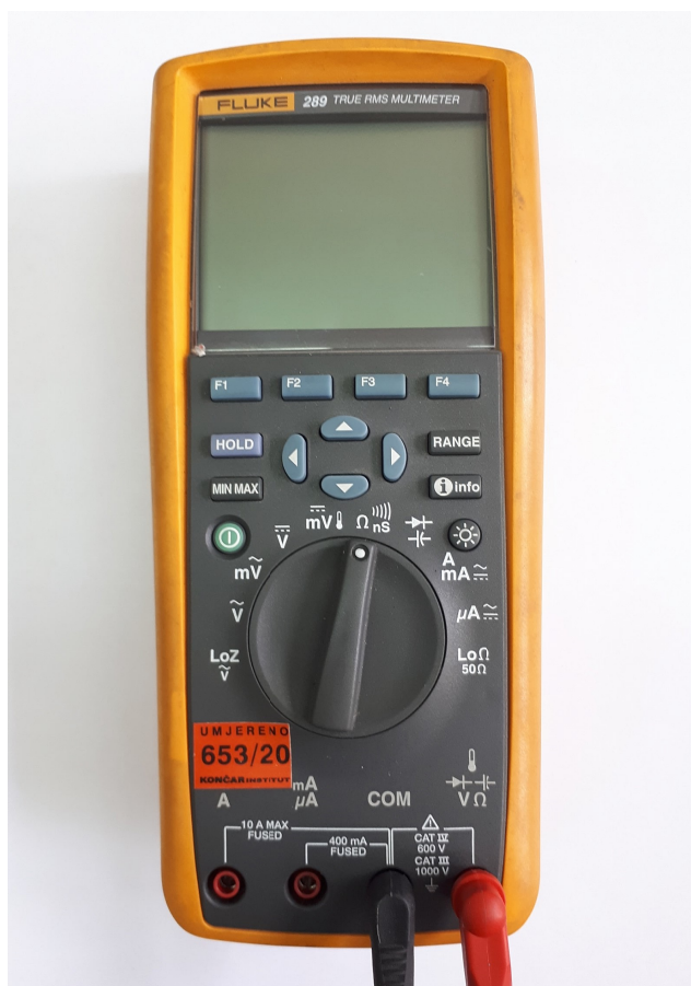
Slika 7.24: Digitalni multimetar Fluke 289
