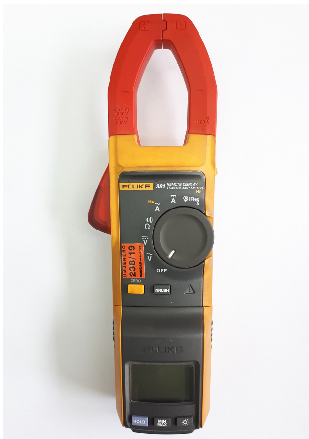
Slika 7.23: Strujna kliješta Fluke 381
