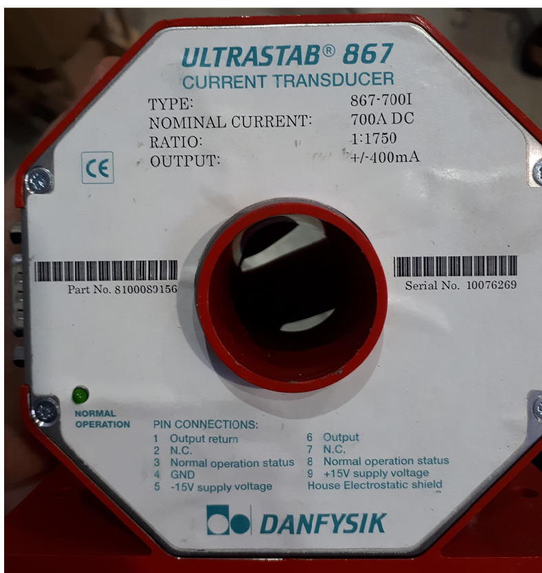
Slika 7.26: Strujna sonda Danfysik Ultrastab 867
