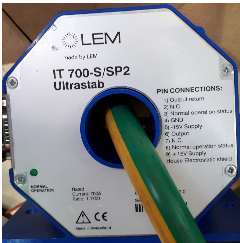
Slika 7.25: Strujna sonda LEM IT 700-S/SP2 Ultrastab
