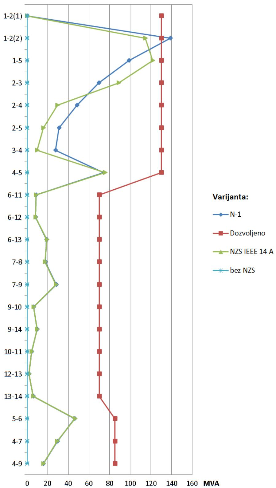
Slika 5.7 Usporedba prividne snage elemenata korištenjem NZS IEEE 14 A
