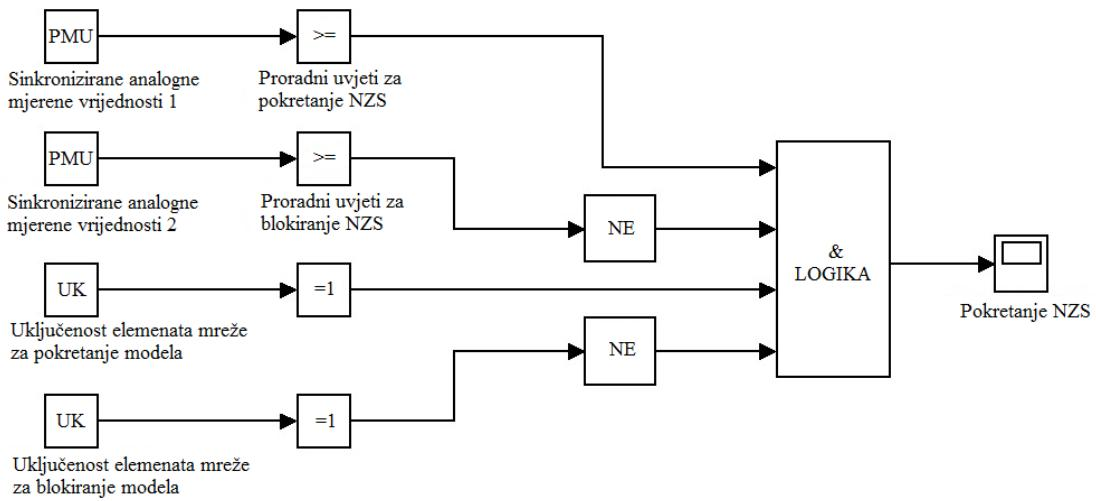
Slika 4.5 Predložak za simuliranje pokretanja napredne zaštitne sheme
