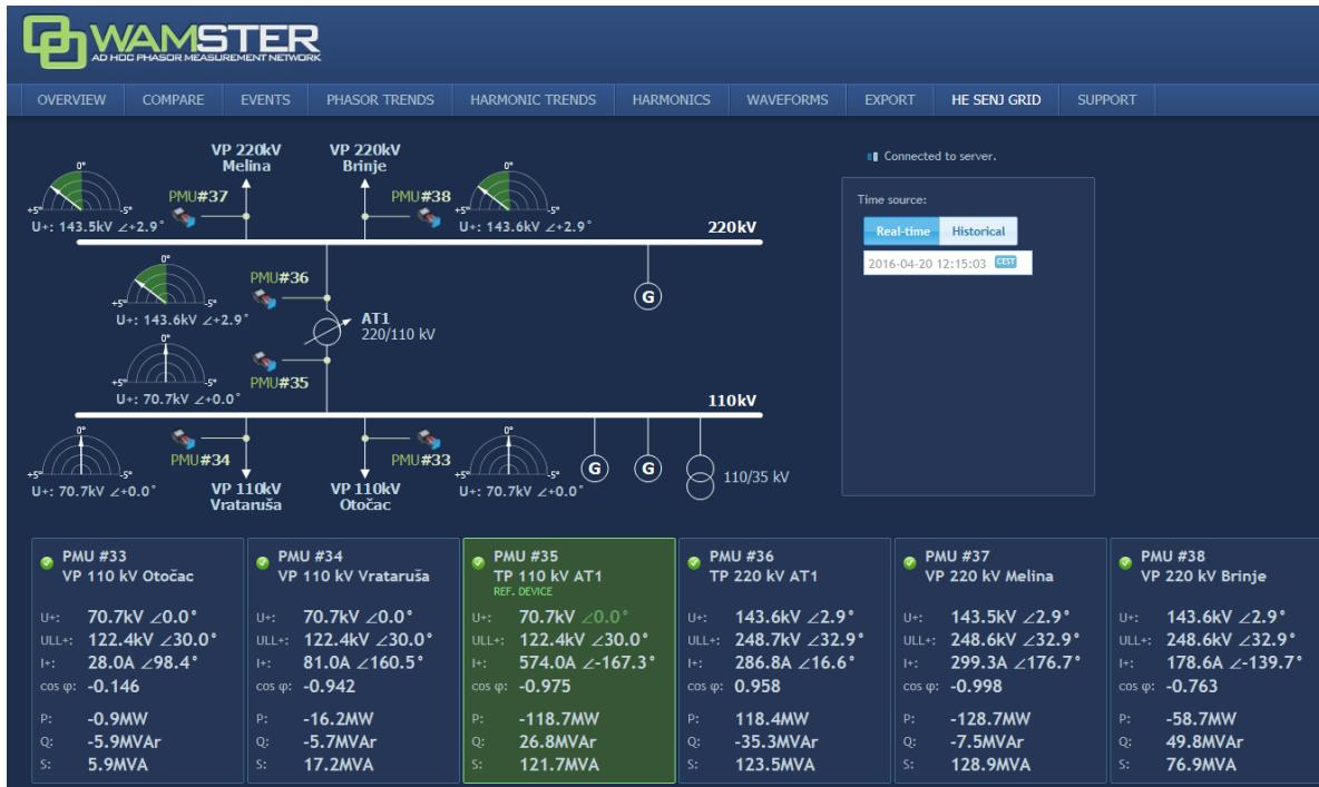
Slika 6.2 Stvarna sinkronizirana mjerenja snimljena korištenjem WAMSTER platforme
