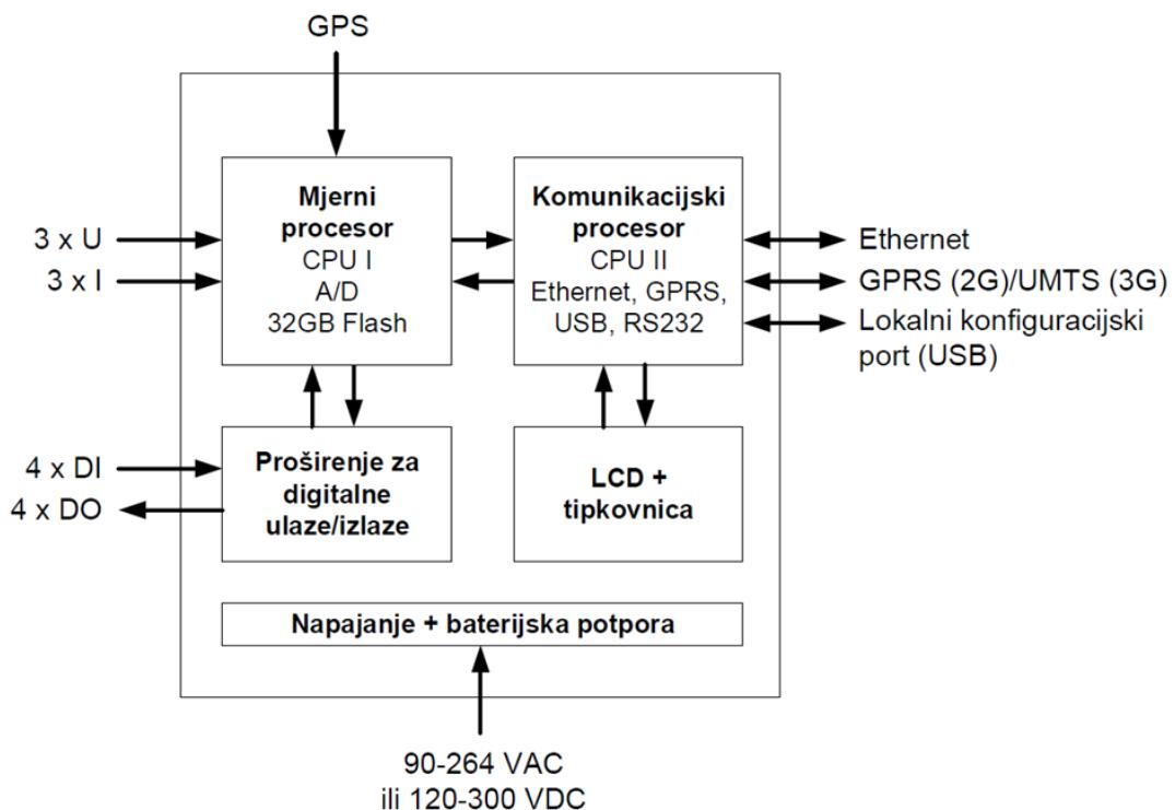
Slika 3.6 Sklopovska blok shema modernog PMU uređaja
