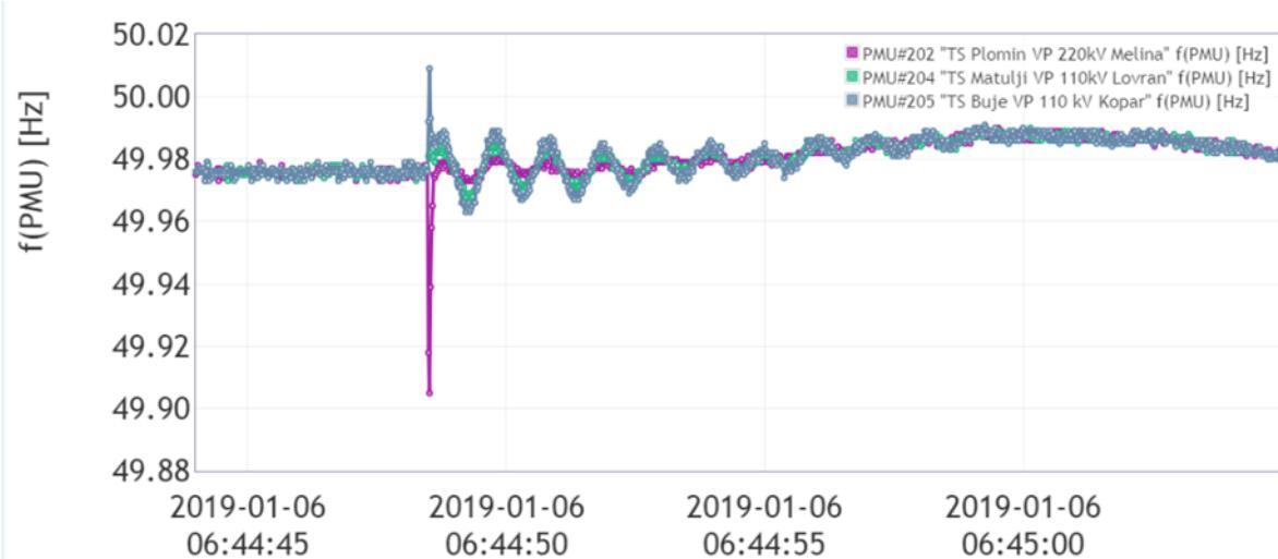
Slika 3.10 Frekvencija u mjerenum točkama EES-a prilikom isključenja DV 220 kV Plomin-Melina
