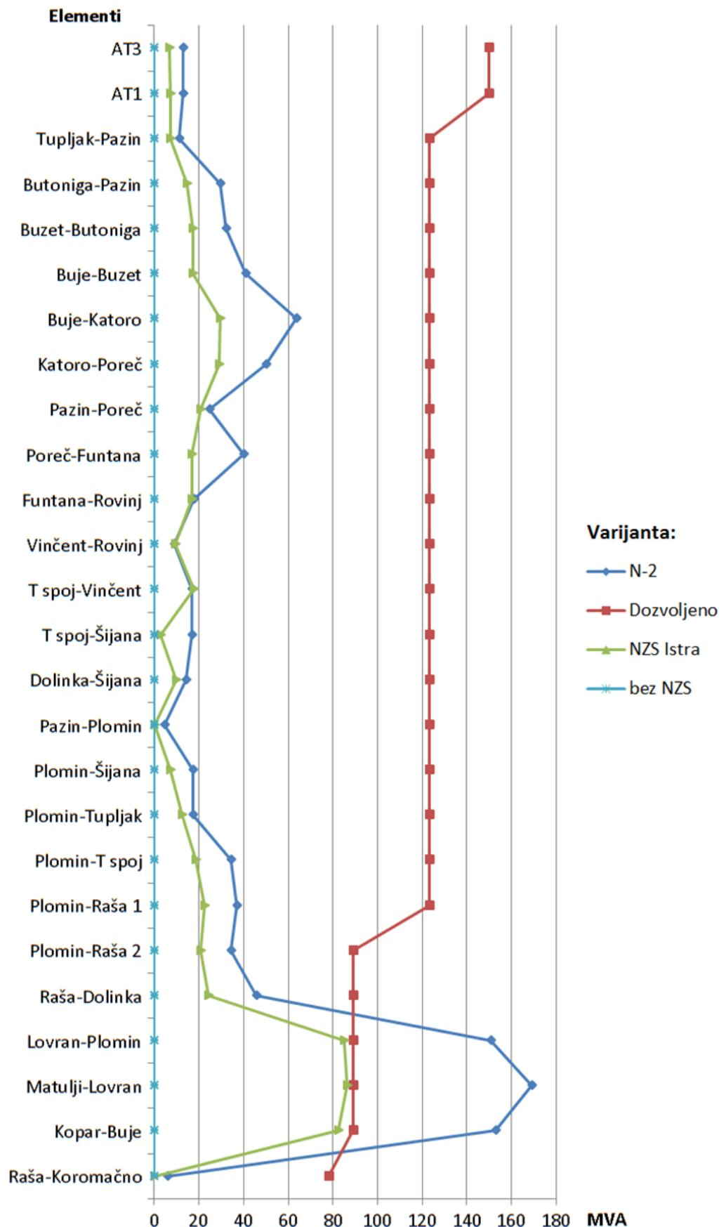
Slika 9.12 Usporedba prividne snage elemenata korištenjem NZS Istra
