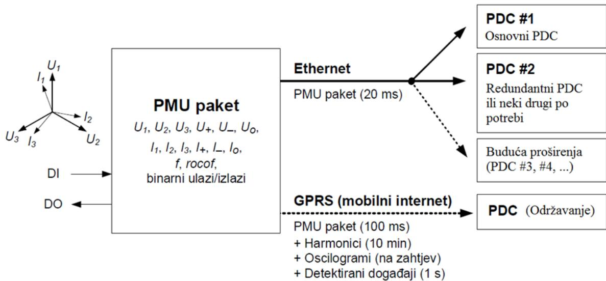
Slika 3.7 Mogućnosti komunikacijske povezanosti modernog PMU uređaja
