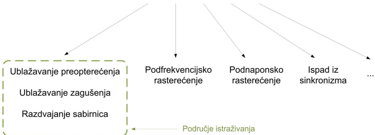
Slika 2.3 Dio funkcija zaštite cjelovitosti sustava
