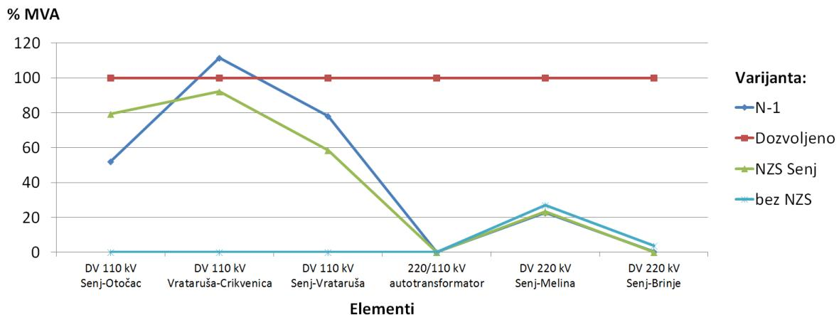
Slika 6.9 Usporedba postotnog iznosa prividne snage elemenata korištenjem NZS Senj
