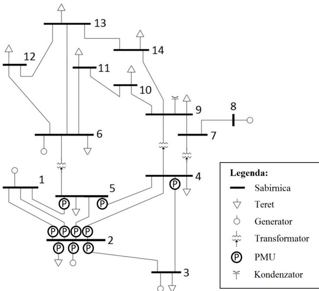
Slika 5.1 IEEE ispitni sustav s 14 sabirnicama s prijedlogom smještaja sinkroniziranih mjernih uređaja za potrebe heurističkog modela za promjenu topologije mreže
