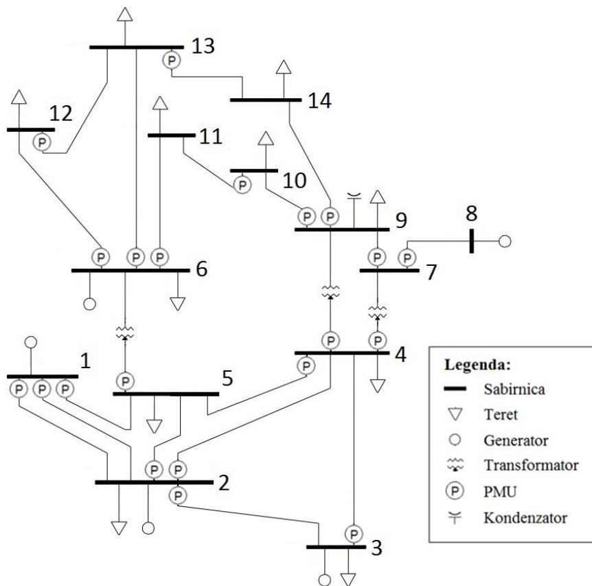
Slika 7.4 IEEE ispitni sustav s 14 sabirnicama s prijedlogom smještaja sinkroniziranih mjernih uređaja za potrebe modela optimalne promjene topologije mreže
