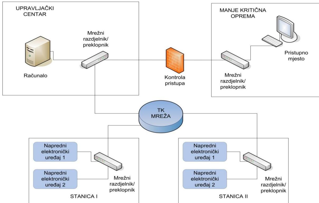
Slika 3.5 Arhitektura sustava zaštite cjelovitosti zasnovana na sinkroniziranim mjerjenjima fazora
