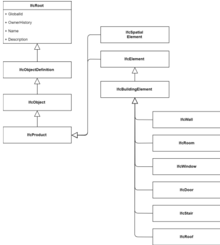
Slika 3.4 Klase IFC modela značajne za optimiranje zaštite
