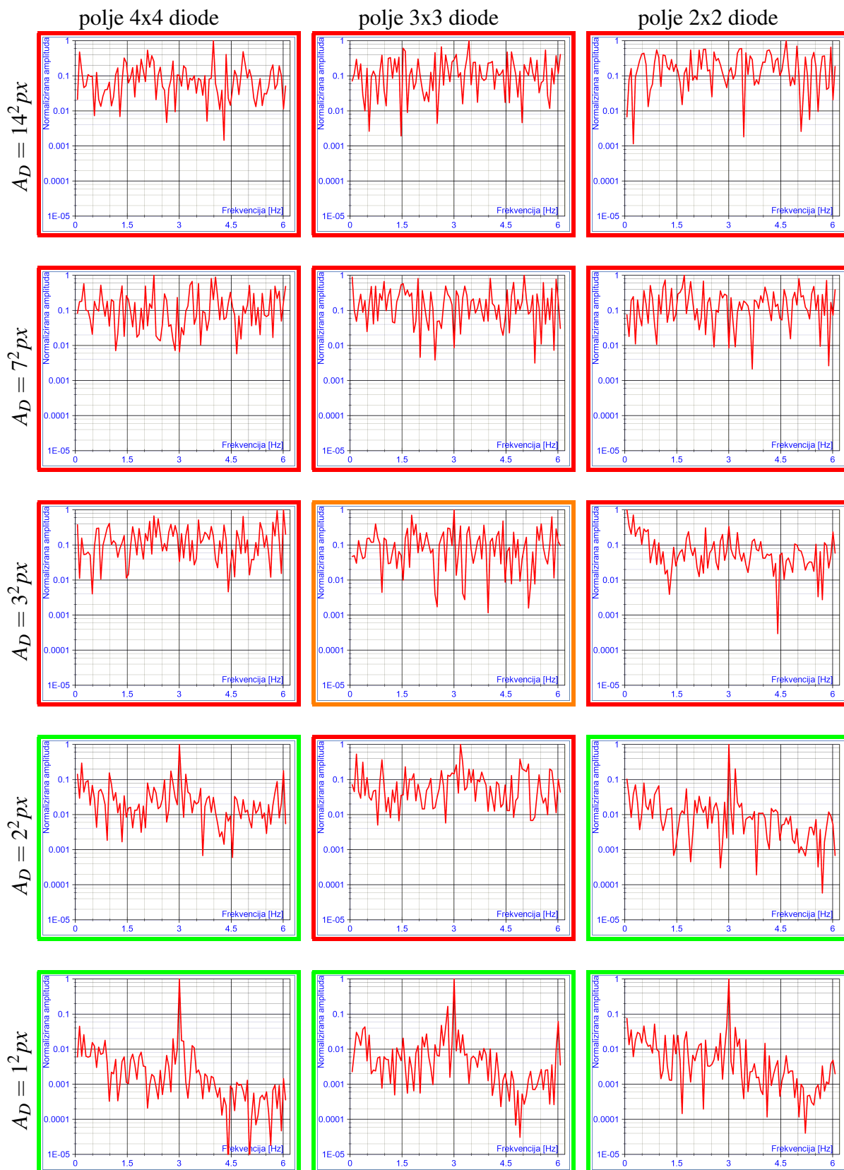
Slika 5.9: Usporedba različitih veličina detektorskih dioda metodom Correlation
