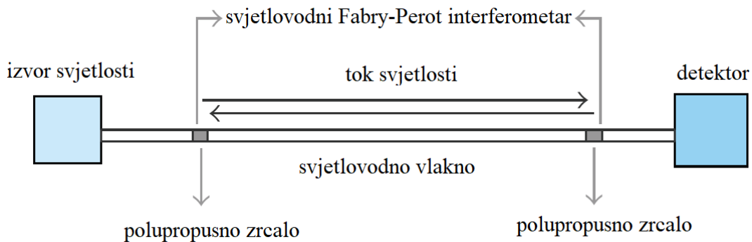
Slika 1.9: Prikaz osnovnih elemenata Fabry-Perot interferometarskog sustava [2].
