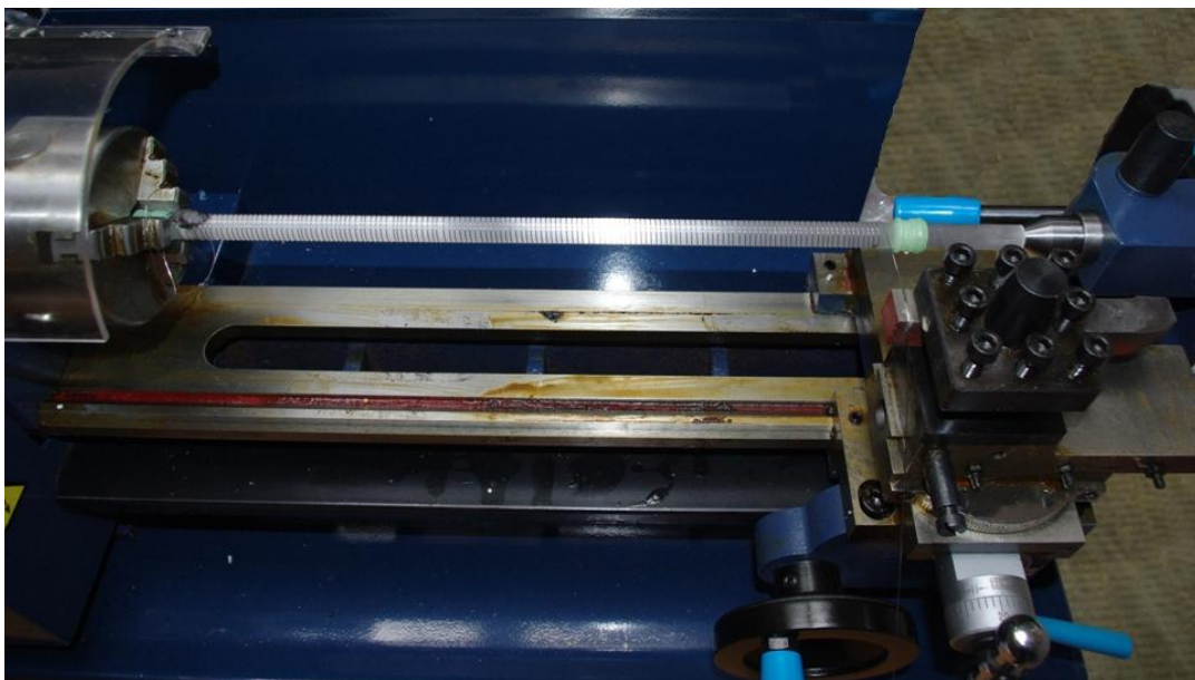
Slika 5.9. Namatanje grijaće žice na reaktorsku cijev korištenjem automatskog posmaka tokarskog stroja. Žica je vođena kroz utor napravljen na tokarskom nožu koji je montiran u nosač alata. Napetost žice tijekom namatanja osiguran je trenjem između svitka s kojeg se odmata žica i njegovog nosača (nisu prikazani na slici).
