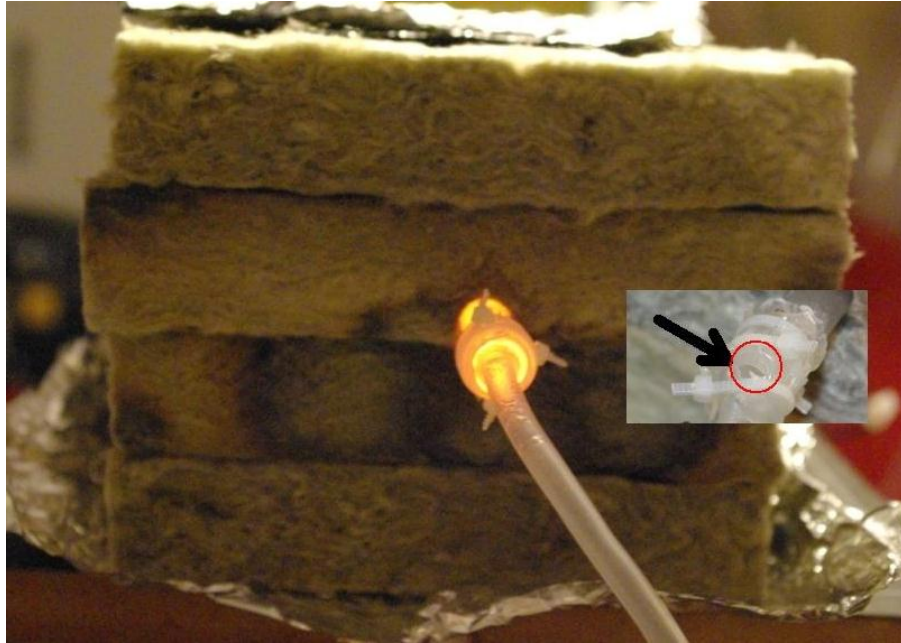
Slika 5.13. Prva verzija priрубnice izvedena proširenim polietilenskim crijevom spojenim direktno na reaktorsku cijev. Prednost je jednostavna konstrukcija a krucijalni nedostak je topljenje crijeva na spojištu uslijed prekomjerne radijacije topline iz reakcijske zone. Umetnuta slika: proboj crijeva (unutar crvenog kruga naznačen crnom strelicom) i otpuštanje poliamidnih vezica uslijed visoke temperature.
