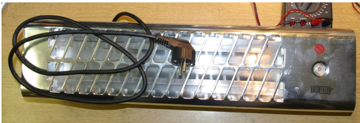
Slika 5.7. Komercijalna infracrvena grijalica korištena u izradi reaktora .
