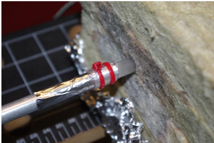
Slika 5.14. Druga verzija priрубnice izvedena aluminijskom cijevi istog promjera kao i reaktorska cijev.
