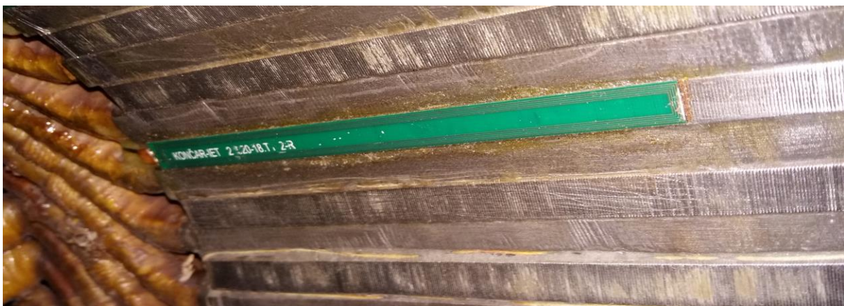
Slika 3.10 Mjerni svitak ugrađen na zub statora
