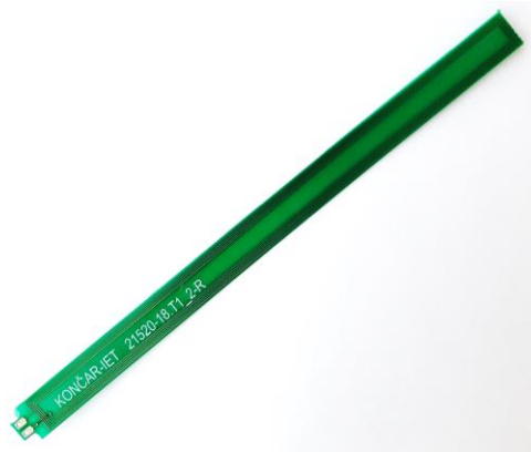
Slika 3.9 Mjerni svitak izrađen u PCB tehnologiji
