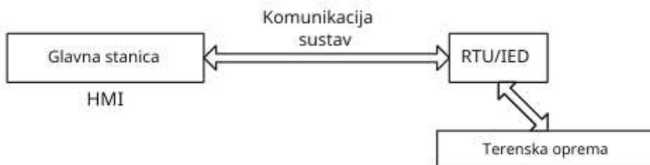
Slika 2.2 Prikaz komponenti SCADA sustava
