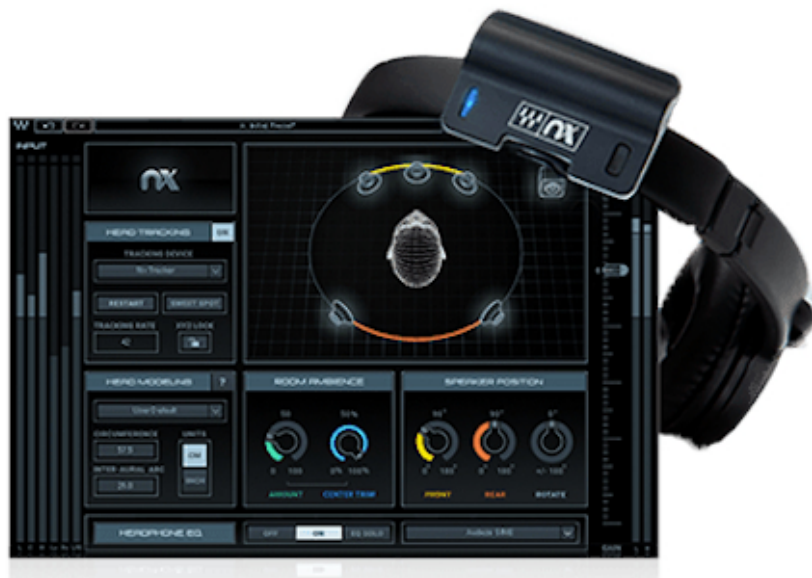
Slika 2.20: Waves NX programski paket i uređaj za praćenje položaja glave [80].
