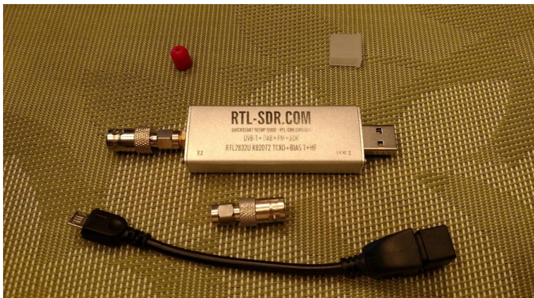
Slika 2.4: Izgled RTL-SDR modela. S jedne strane ima ulaz za USB, dok sa druge strane ima priključak za antenu
