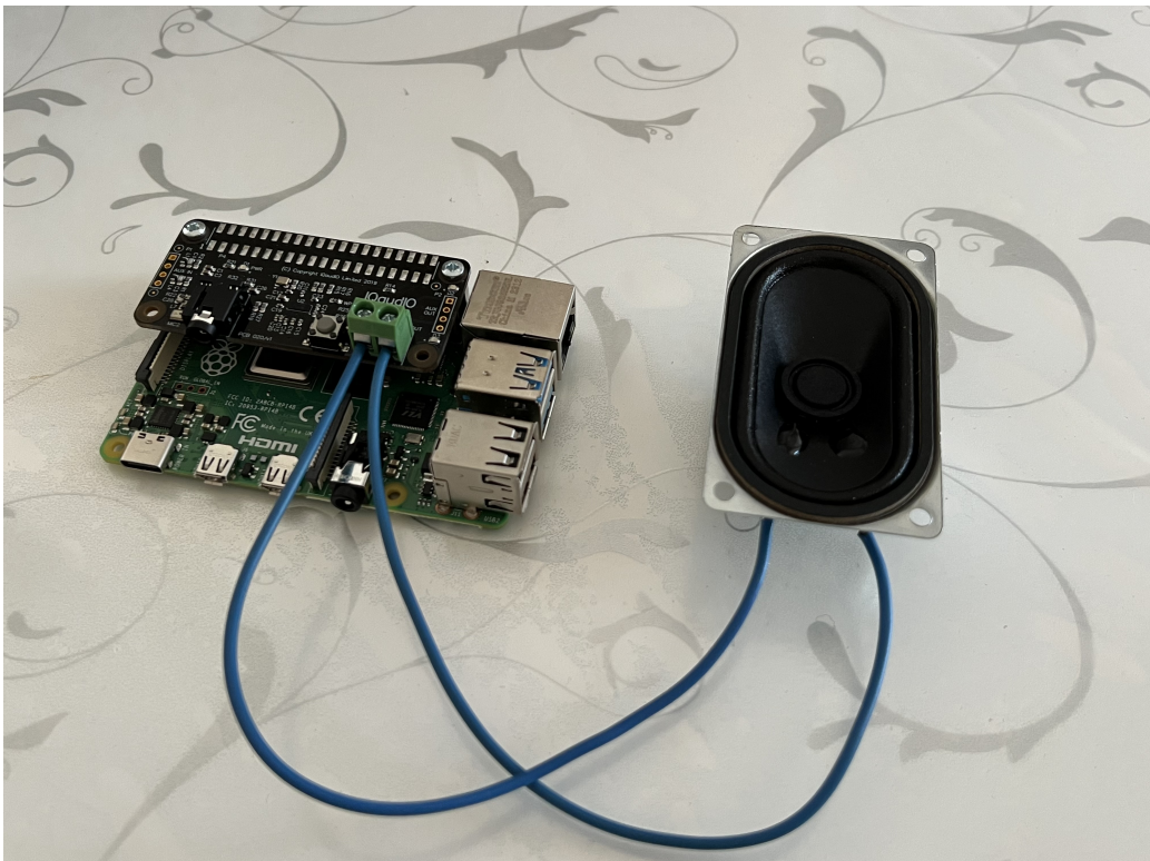
Slika 3.11: Raspberry Pi 4B s Codecom i zvučnikom
