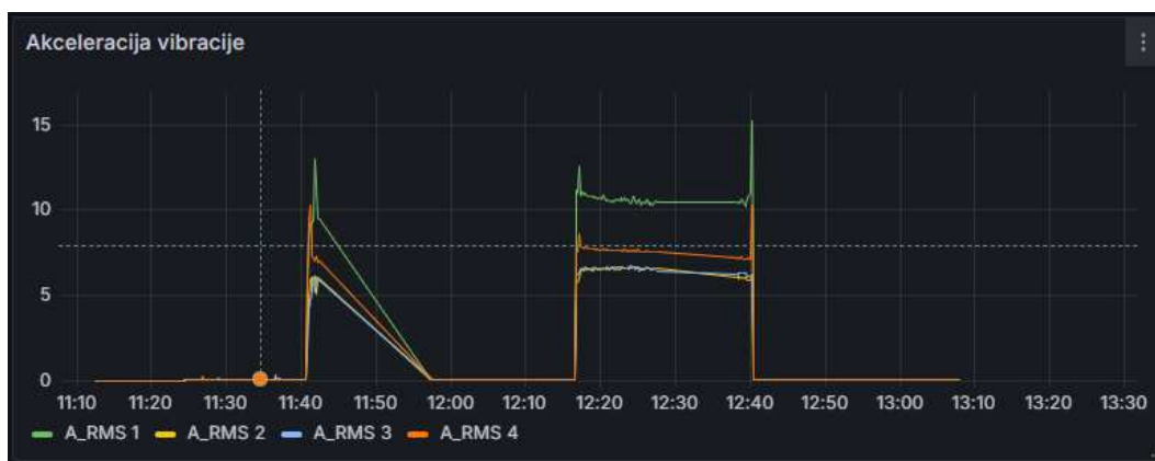
Slika 3.4.16 Prikaz akceleracija vibracije
