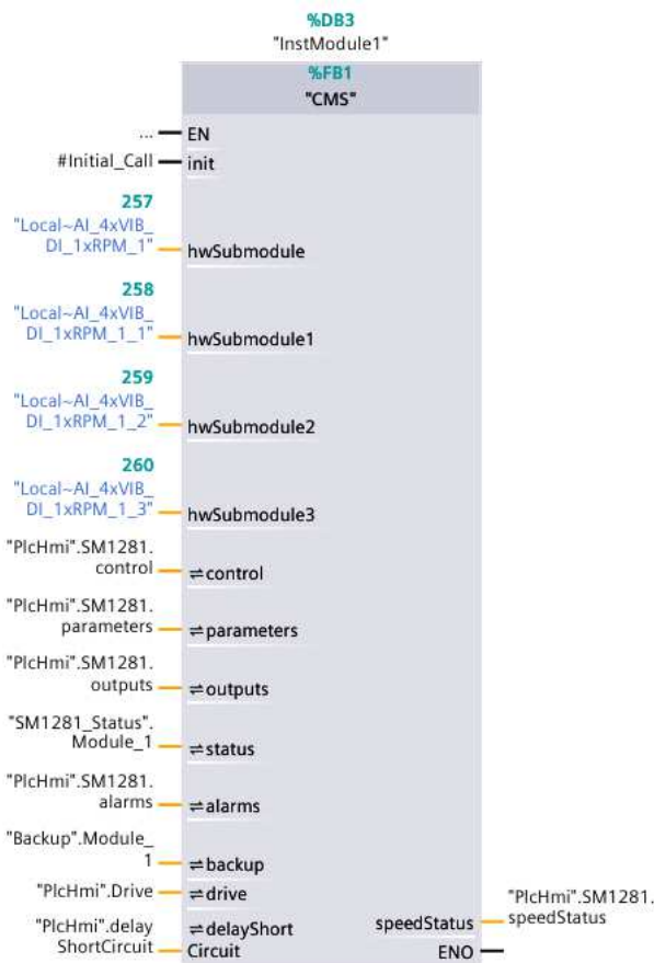
Slika 3.1.3 Poziv funkcijskog bloka CMS
