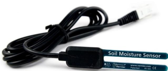
Slika 2.16 Senzor vlage tla
