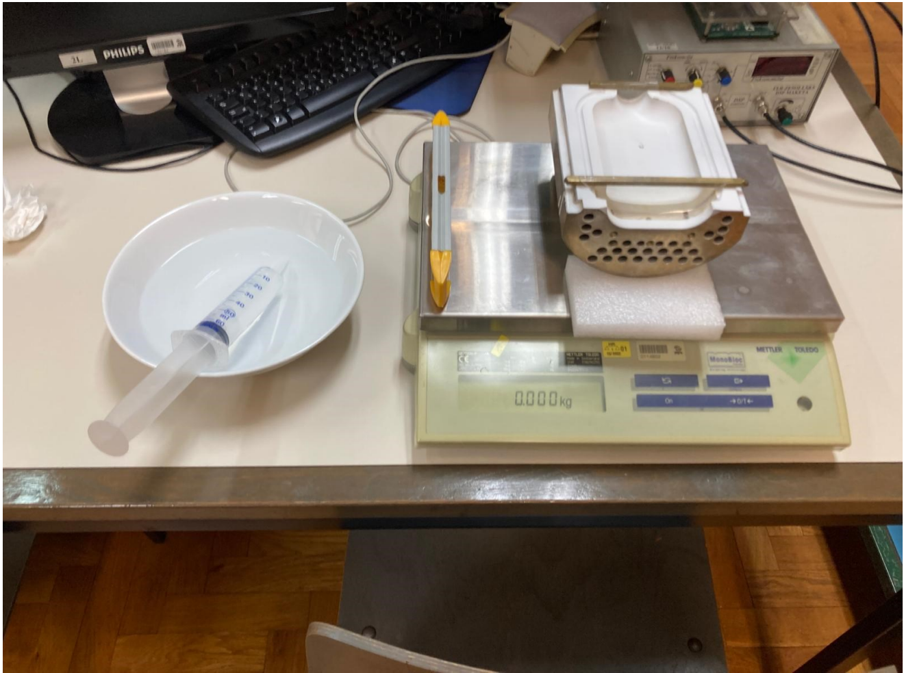
Slika 17 - Mjerenje volumena kalupa vodom
