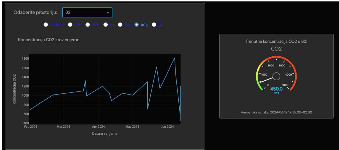
Slika 2.2 Graf ovisnosti koncentracije CO 2 o vremenu (lijevo) i mjerач (desno) u prostoriji B2
