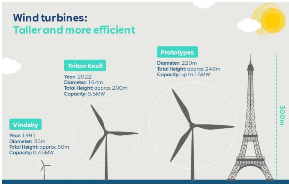
Slika 4.2: Usporedba veličina različitih offshore vjetroturbina [2]
