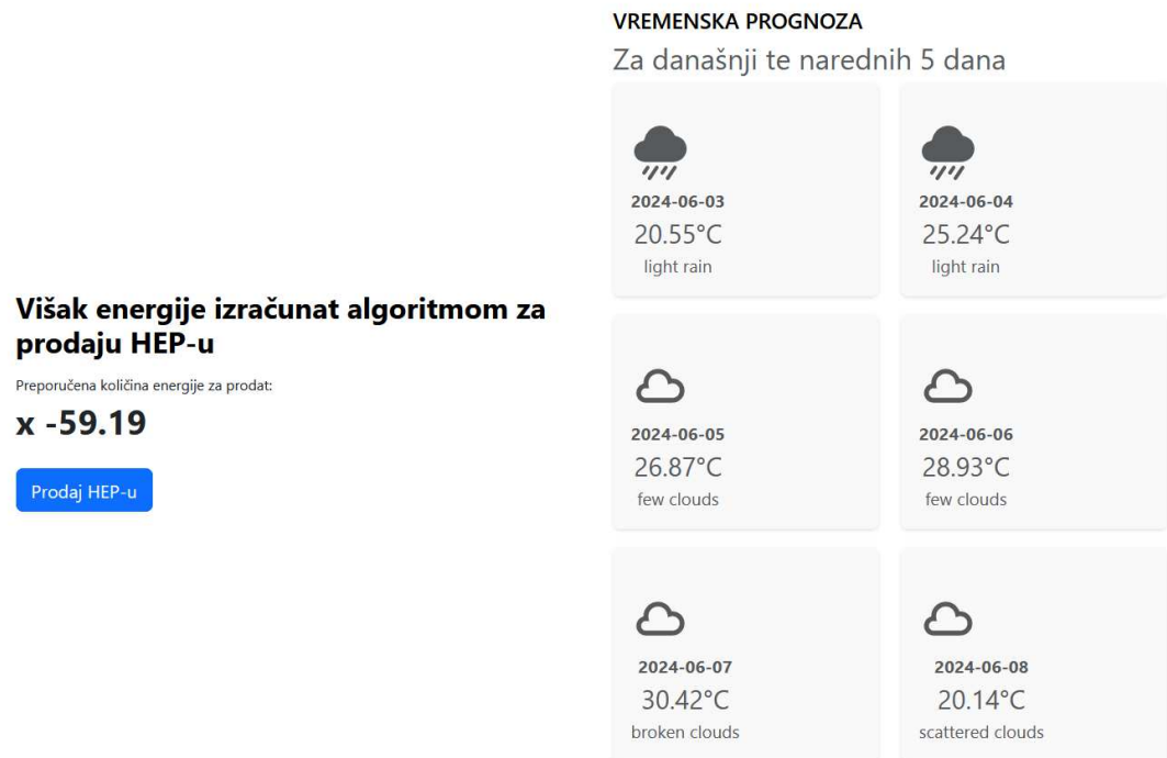
Slika 2.6. Prikaz vremenske prognoze te optimalnog viška energije
