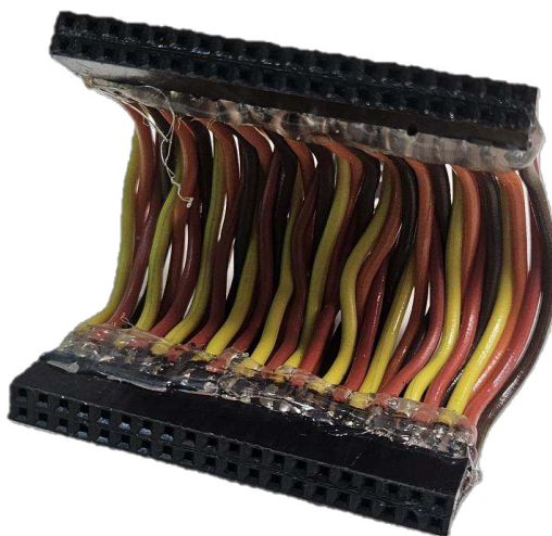
Slika 5.1. konektor za povezivanje 40 ulazno/izlaznih priključaka
