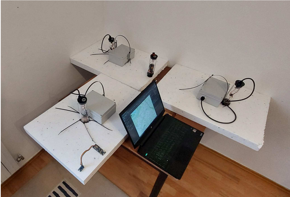
Slika 5.1: Posloženi testni postav vodenih jedinica
