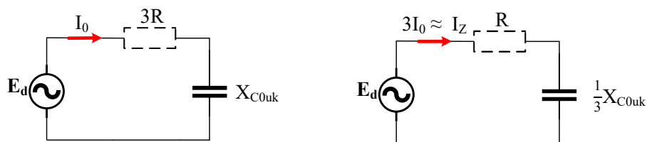
Slika 2.9: Pojednostavljena nadomjesna shema mreže s izoliranim zvjezdištem
