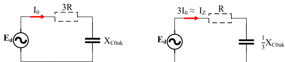
Slika 2.9: Pojednostavljena nadomjesna shema mreže s izoliranim zvjezdištem
