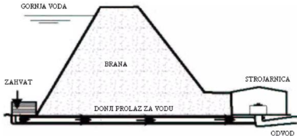
Slika 1.1 Prikaz niskotlačne MHE sa strojarnicom na dnu brane [10]
