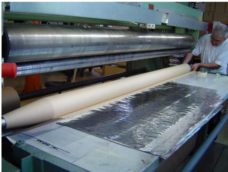
Slika 7.16 – Namatanje kondenzatorskog tijela 245 kilovoltnog provodnika
