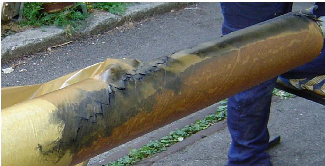
Slika 4.7 – Trag kliznog proboja iniciranog s gornjeg ruba obloge
