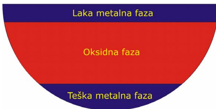
Slika 2-17: Inverzno uslojavanje rastaljenog materijala
