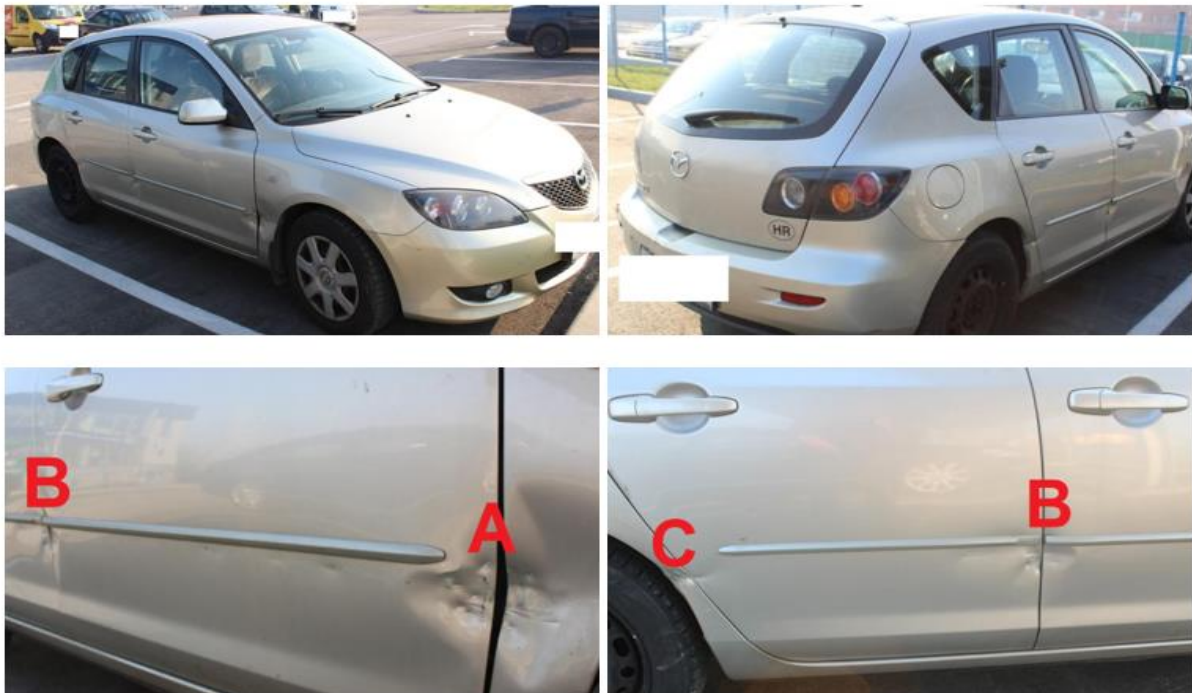
Slika 2.6. Fotografije prijavljenih oštećenja navodno nastalih od kontakta s priključnom cijevi traktora Izvor: osiguratelj iz RH
